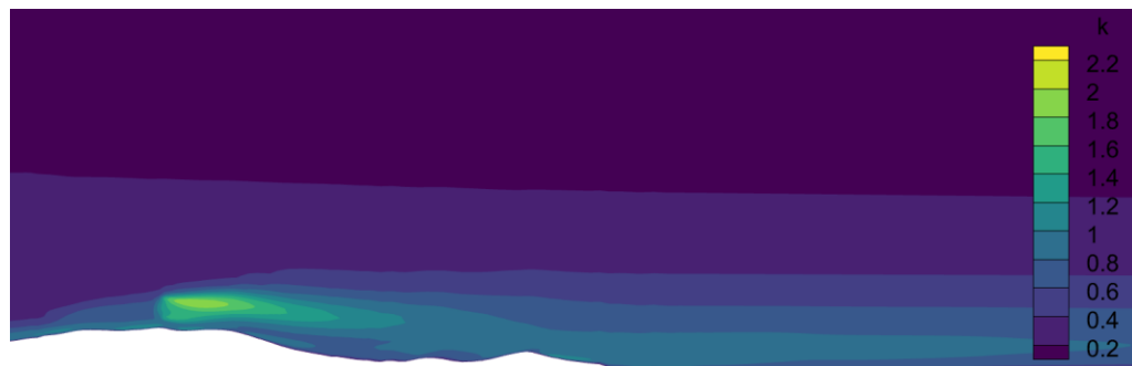
Εικόνα 2.1.5.2.6: Απεικόνιση του πεδίου της κινητικής ενέργειας της τύρβης για πλάτος y = 4390\text{m}
