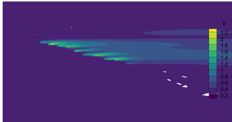
Εικόνα 2.1.5.2.4: Απεικόνιση του πεδίου της κινητικής ενέργειας της τύρβης για ύψος z = 240\text{m}
