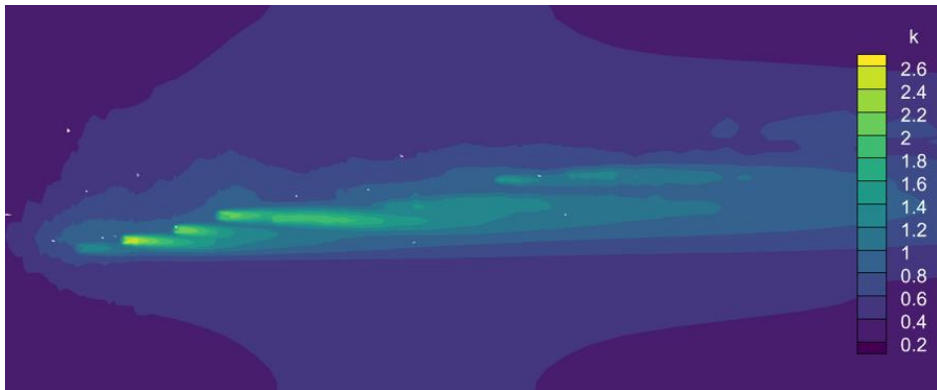
Εικόνα 2.1.5.1.9: Απεικόνιση του πεδίου της κινητικής ενέργειας της τύρβης για ύψος z = 260\text{m}
