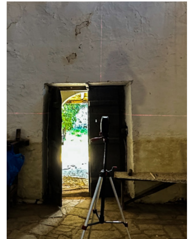
Εικ.06| Χρήση αλφαδολείζερ για τη χωροστάθμιση. 08/2023.
