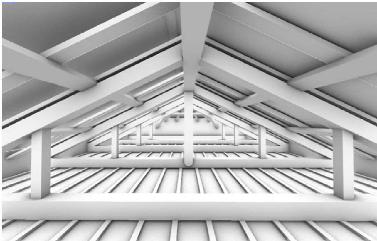
Σχ. 28 | Μοντέλο της υφιστάμενης κατάστασης της στέγης του ναού. Λήψεις της δομής της στέγης από το δυτικό δοκάρι του ψευδοθόλου προς τη δυτική όψη.
