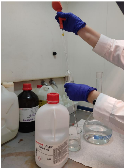
Εικόνα 48: Παρασκευή εκχυλιστικού μέσου (θειικό οξύ).
