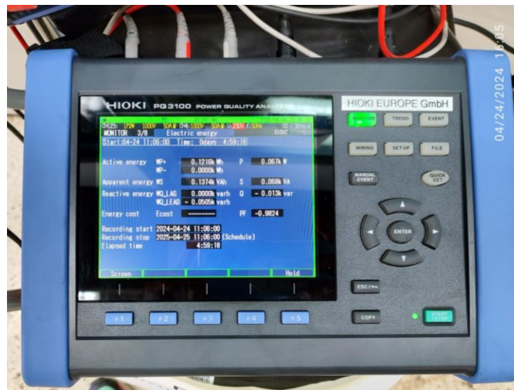
Εικόνα 52: Μέτρηση κατανάλωσης ενέργειας κατά την εκχύλιση.
