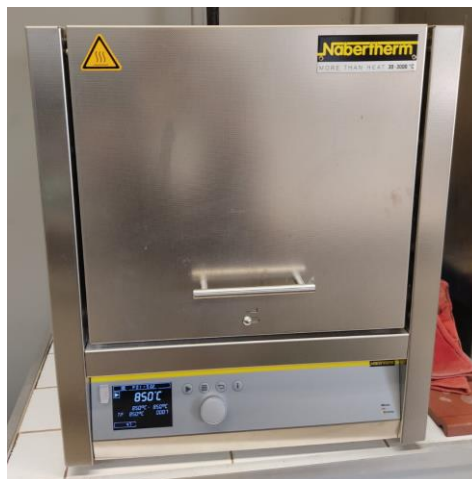
Εικόνα 24: Κλίβανος υψηλών θερμοκρασιών που χρησιμοποιήθηκε για τον προσδιορισμό της απώλειας πύρωσης.
