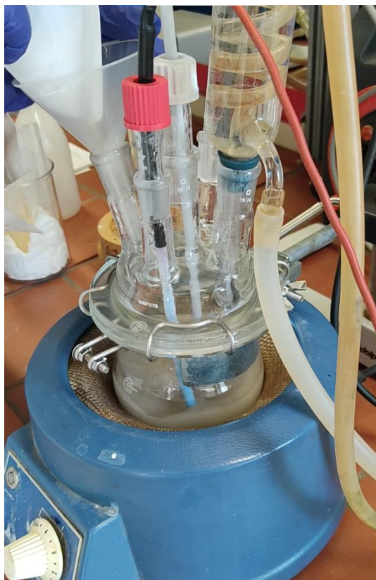
Εικόνα 49: Εκχύλιση μίγματος σποδουμένη με \text{Na}_2\text{CO}_3 σε σφαιρικό αντιδραστήρα, με ανάδευση και ταυτόχρονη θέρμανση.
