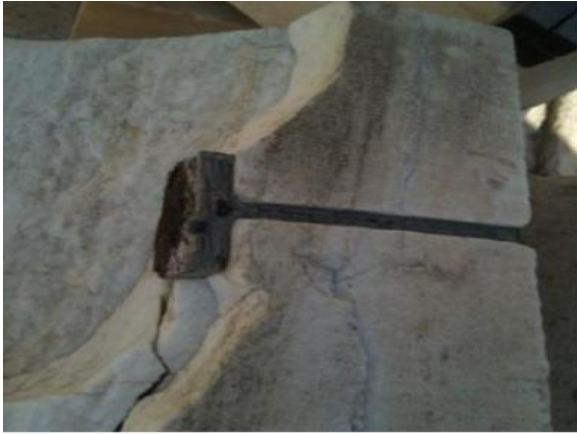
Εικόνα 14 Δείγμα Νο 3. Ήμισυ συνδέσμου «Ταυ» από συμπλήρωμα του άβακα του κιονοκράνου. Αριθμός Αποξήλωσης: 14149.
