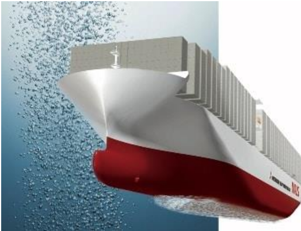
Εικόνα 6: Σύστημα αερολίπανσης της γάστρας σε πλοίο μεταφοράς εμπορευματοκιβωτίων (Marine Insight, 2021)
