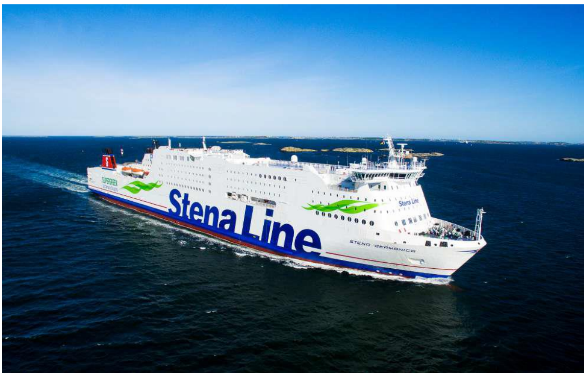
Εικόνα 7: Το επιβατηγό πλοίο που χρησιμοποιεί μεθανόλη ως καύσιμο, Stena Germanica, με καθαρό βάρος 50,000 DWT (IRENA, 2021)
