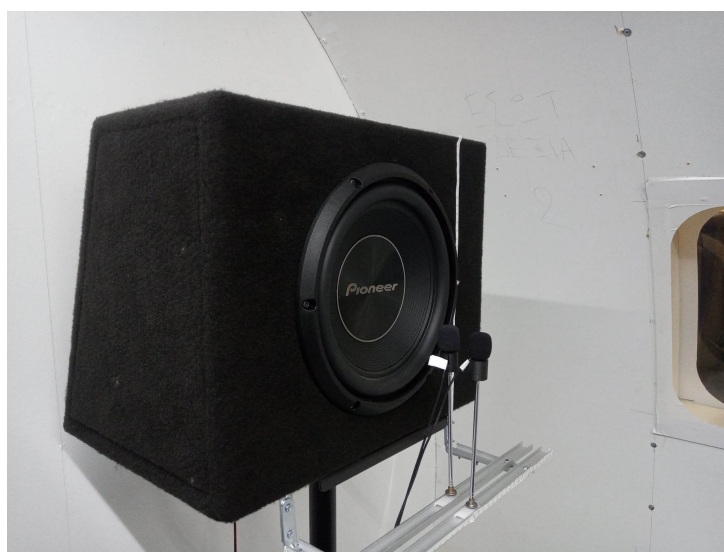
Σχήμα 12: Ο ενεργός απορροφητής ήχου με δύο μικρόφωνα, που εφαρμόζει τη μέθοδο p-p για το διαχωρισμό του ακουστικού κύματος σε προσπίπτον και ανακλώμενο.
