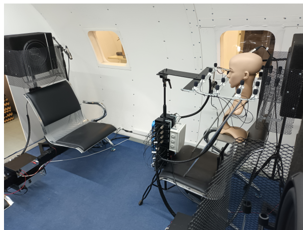
Σχήμα 10: Τοπικά συστήματα ΕΕΘ, τοποθετημένα απέναντι το ένα στο άλλο, μέσα στο ομοίωμα καμπίνας μικρού αεροσκάφους που έχει εγκατασταθεί στο Εργαστήριο Δυναμικής και Ακουστικής.
