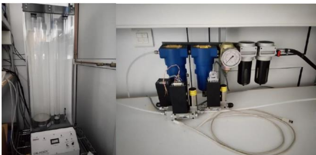
Εικόνα 5.22: Το πρωτεύον σύστημα βαθμονόμησης ροής μάζας του ΕΜΠ (αριστερά) και η τοποθέτηση των ροόμετρων μάζας (δεξιά).
