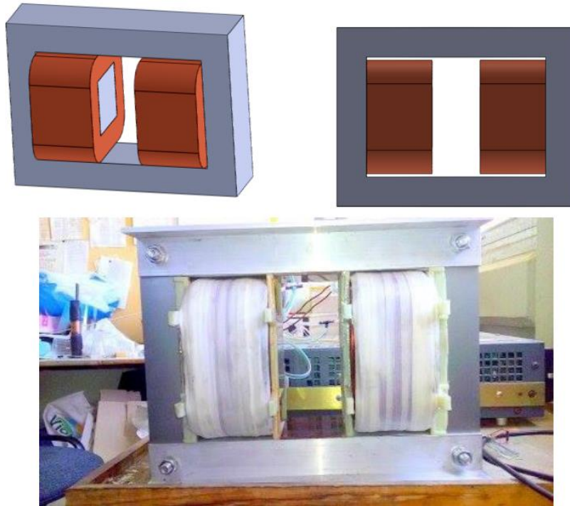
Εικόνα 5.13: Ηλεκτρομαγνήτης που χρησιμοποιείται για πειράματα παραγωγής υδρογόνου.
