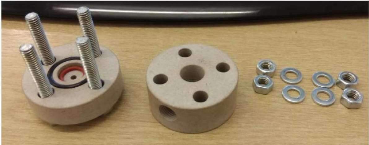
Εικόνα 5.4 Αντιδραστήρας τεφλόν για θερμοκρασία έως 200°C.
