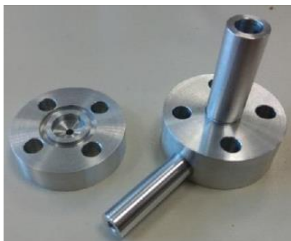
Εικόνα 5.5: Αντιδραστήρας αλουμινίου για θερμοκρασία λειτουργίας έως 300 °C.
