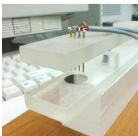
Εικόνα 6.14: Έλεγχος της αντίστασης με τη μέθοδο τεσσάρων σημείων που χρησιμοποιείται για την παρακολούθηση της αντίστασης των δισκίων και των λεπτών υμενίων.
