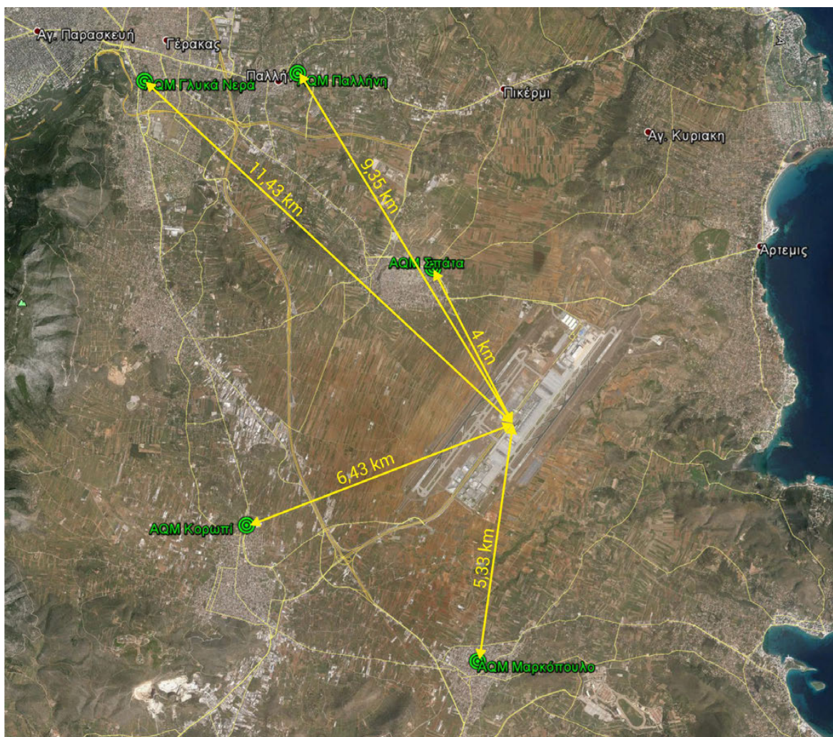
Σχήμα 10: Το δίκτυο σταθμών παρακολούθησης της ποιότητας αέρα γύρω από τον ΔΑΑ, με ένδειξη των αποστάσεων κάθε σταθμού από τον πύργο ελέγχου.
