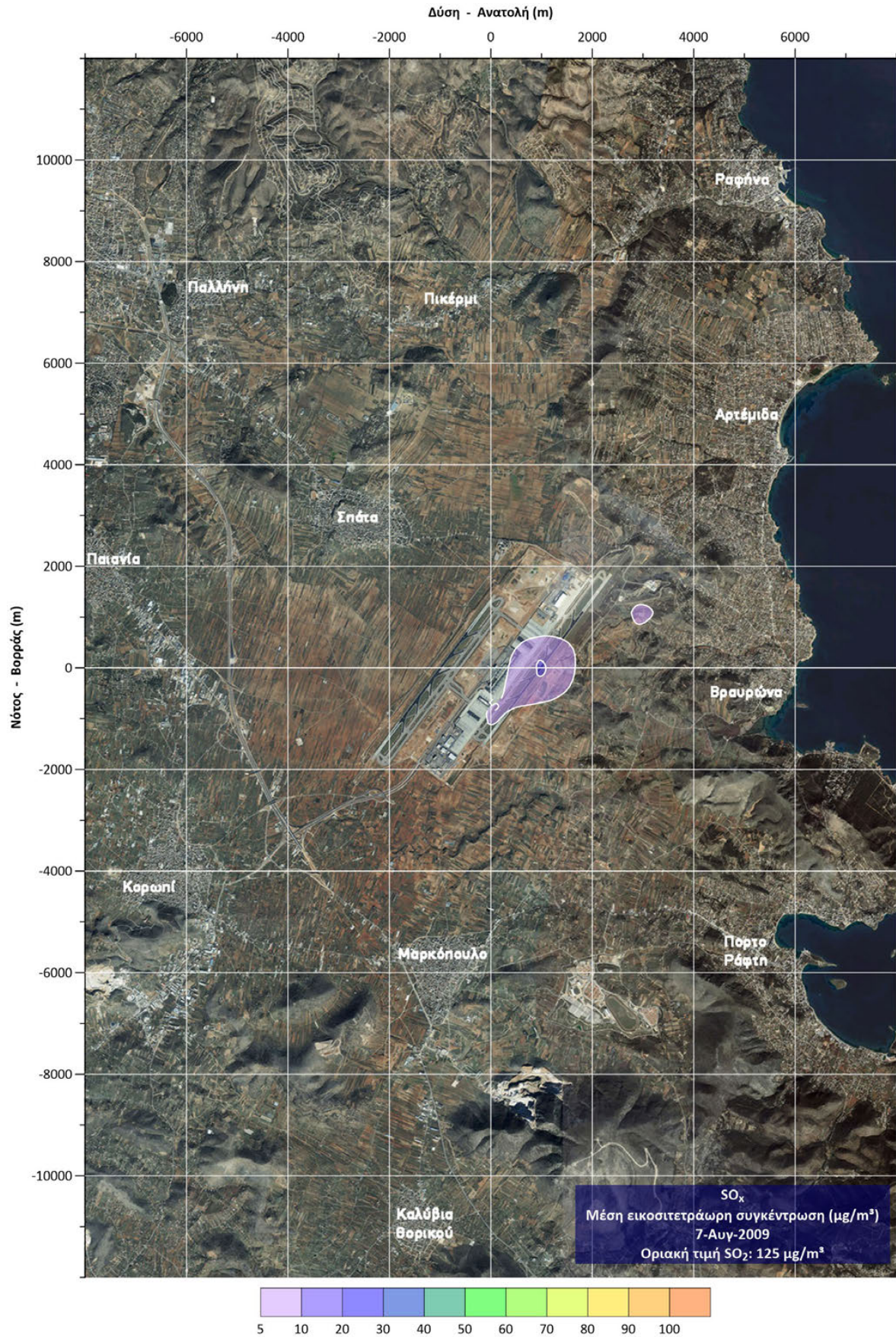
Γράφημα 41: Συγκέντρωση SO x στο δυσμενέστερο 24ωρο του πρώτου δεκαήμερου Αυγούστου στον ΔΑΑ.
