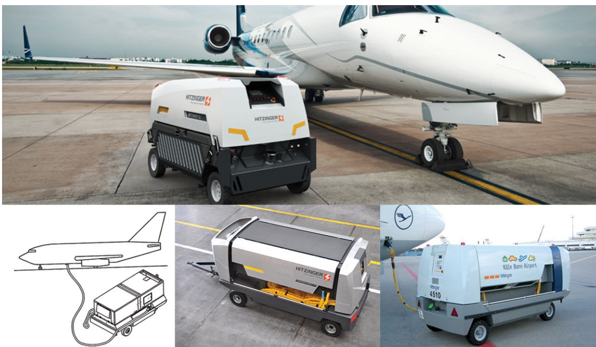
Σχήμα 31: Εικόνες τυπικής ηλεκτροπαραγωγού μονάδας εδάφους (GPU) και σύνδεσής της με το αεροσκάφος.
