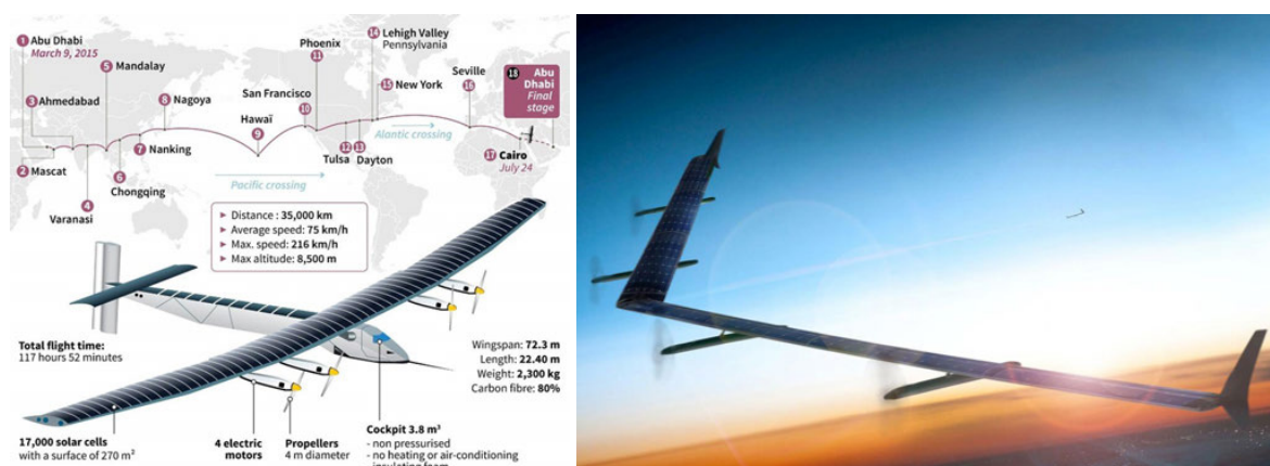
Σχήμα 34: Εικόνες από το ηλιακό ηλεκτροκίνητο μέλλον της αεροπορίας, το οποίο όμως απέχει ακόμη αρκετές δεκαετίες.
