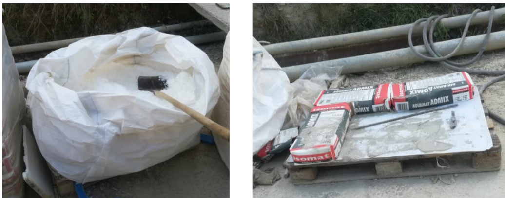
Εικόνα 4.8: Ίνες πυροπροστασίας και σταθεροποιητές σκυροδέματος
