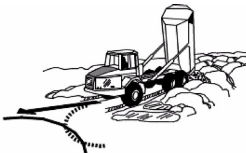
Εικόνα 2-9: Απόρριψη του φορτίου κατευθείαν πάνω στο υλικό σε υγρές συνθήκες με σκοπό τη συμπύκνωση του [1]
