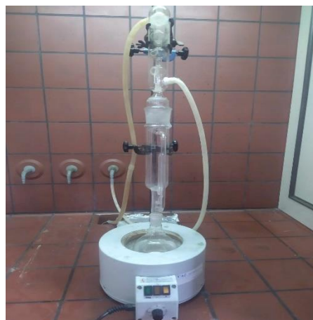
Εικόνα 30: Διάταξη εκχύλισης Soxhlet (δεξιά φωτογραφία από το εργαστήριο)
