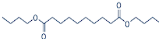
Εικόνα 10: Δομή πλαστικοποιητή DBS
