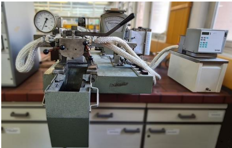
Εικόνα 22: Εσωτερικός αναμικτήρας Brabender Εργαστηρίου Τεχνολογίας Πολυμερών ΕΜΠ
