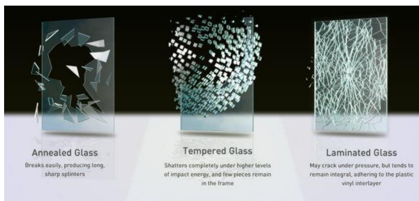
Εικόνα 11: Η χρήση του πλαστικοποιητή βοηθάει στην αντοχή στη κρούση στο πολυστρωματικό σύνθετο γυαλιού-PVB (laminated glass)
