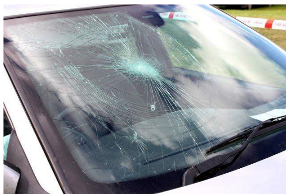
Εικόνα 12: Η εφαρμογή του PVB στα παρμπρίζ των αυτοκινήτων ενισχύει την ασφάλεια των επιβατών συγκρατώντας τα θραύσματα από κάποια ενδεχόμενη κρούση.
