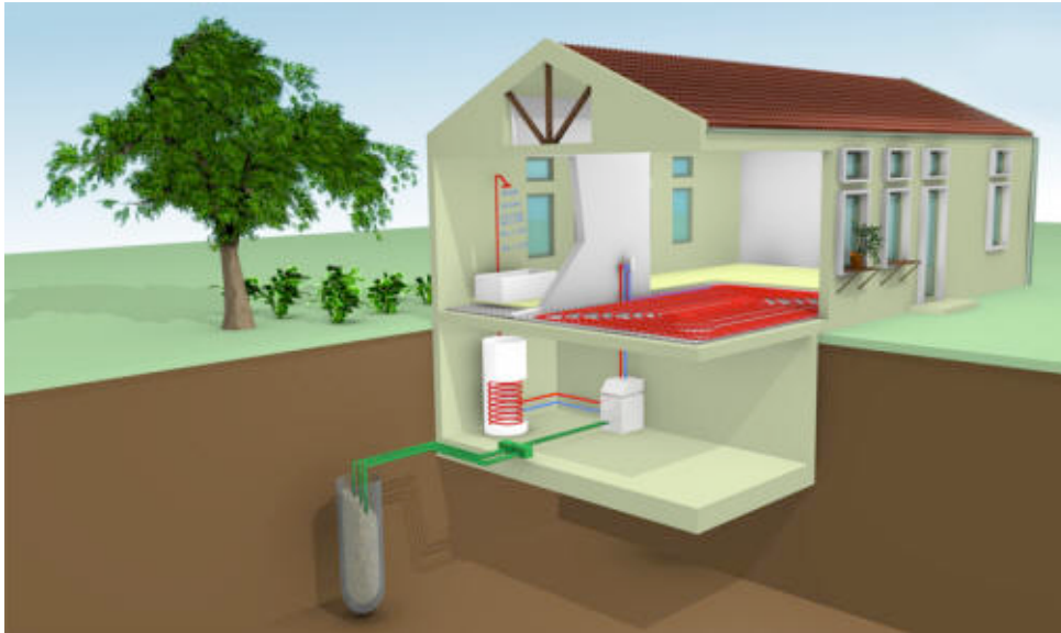
Εικόνα 3.3. : Γεωθερμία (Κάθετη Διάταξη)
