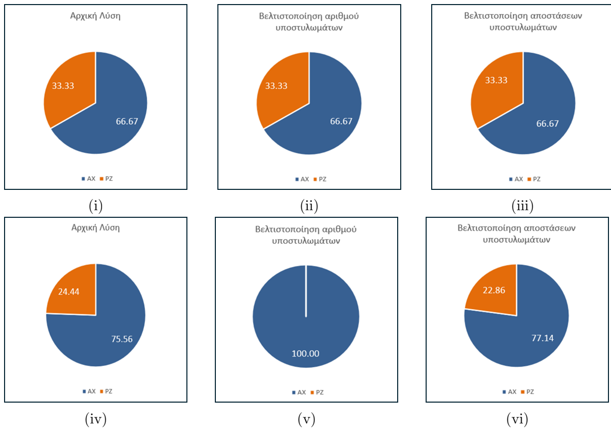
Σχήμα 49: Σύγκριση των ποσοστών των υποστυλωμάτων και των δοκών που βρίσκονται στις στάθμες 'Άμεση Χρήση' και 'Προστασία Ζωής' υπό τη δράση σεισμού με πιθανότητα υπέρβασης 50% στα 70 χρόνια για κάθε λύση του κτηρίου της εφαρμογής 2. Τα διαγράμματα 49i, 49ii, 49iii αναφέρονται στα υποστυλώματα, ενώ τα διαγράμματα 49iv, 49v, 49vi αναφέρονται στις δοκούς.
