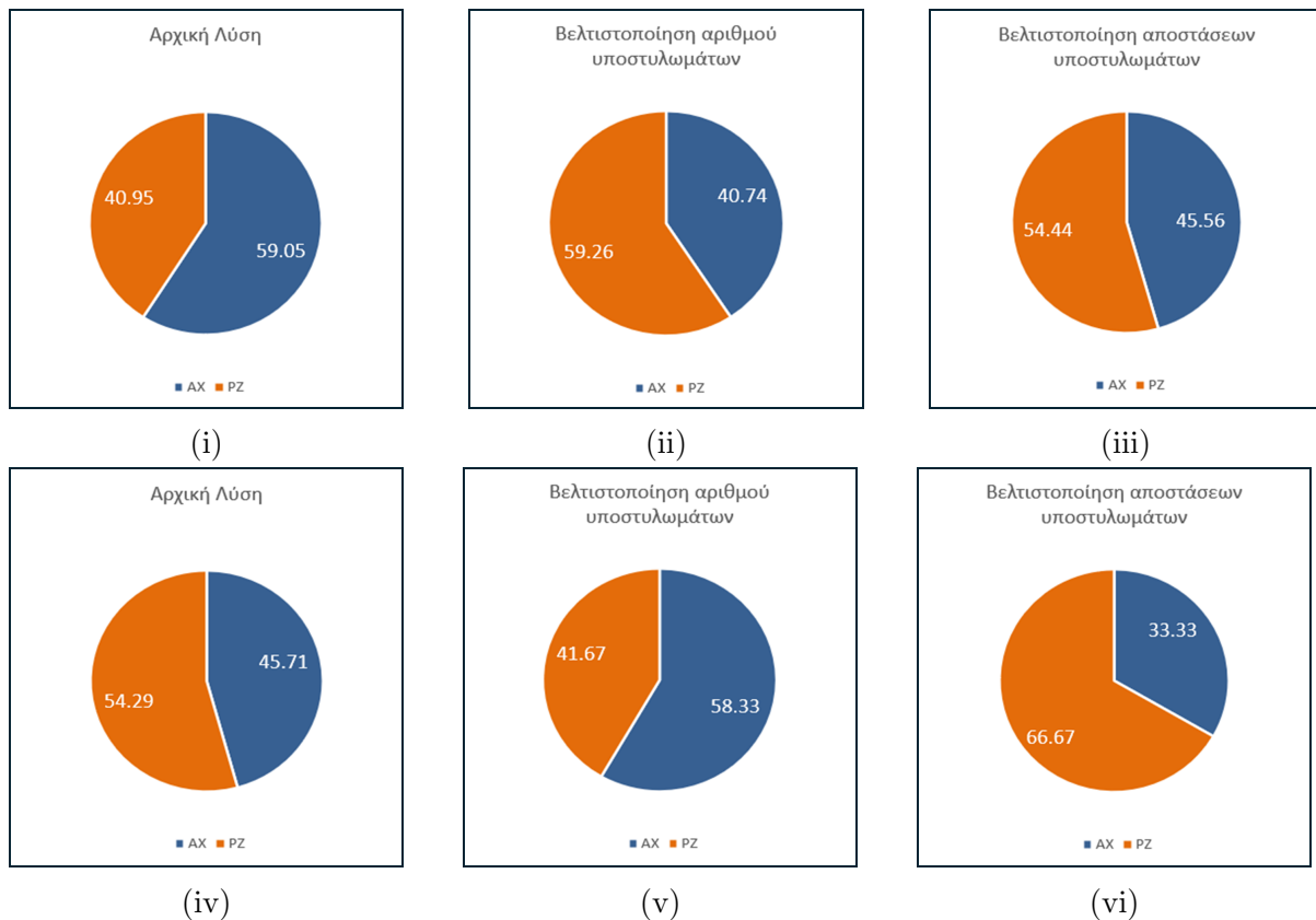
Σχήμα 50: Σύγκριση των ποσοστών των υποστυλωμάτων και των δοκών που βρίσκονται στις στάθμες 'Άμεση Χρήση' και 'Προστασία Ζωής' υπό τη δράση σεισμού με πιθανότητα υπέρβασης 10% στα 475 χρόνια για κάθε λύση του κτηρίου της εφαρμογής 1. Τα διαγράμματα 39i, 39ii, 39iii αναφέρονται στα υποστυλώματα, ενώ τα διαγράμματα 39iv, 39v, 39vi αναφέρονται στις δοκούς.
