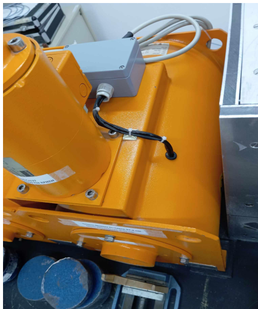
Εικόνα 4.2: Θωράκιση πηγής Cs-137 STS-OB6.
