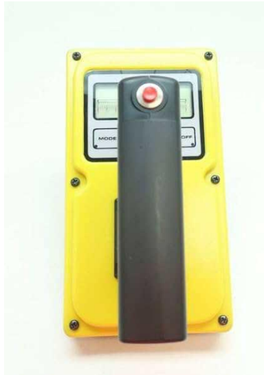
Εικόνα 3.10: Θάλαμος Ιονισμού Model 450P πεπιεσμένος. [14]
