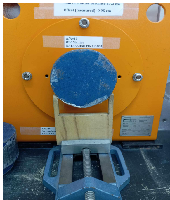
Εικόνα 4.16: Πρόσψη διάταξης με χρήση απορροφητή μολύβδου
