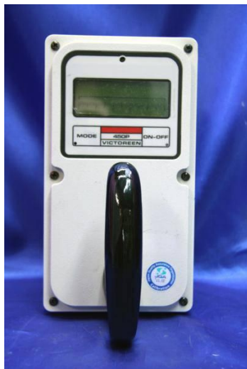
Εικόνα 3.13: Θάλαμος Ιονισμού Model 450 ασυμπέριστος [14]
