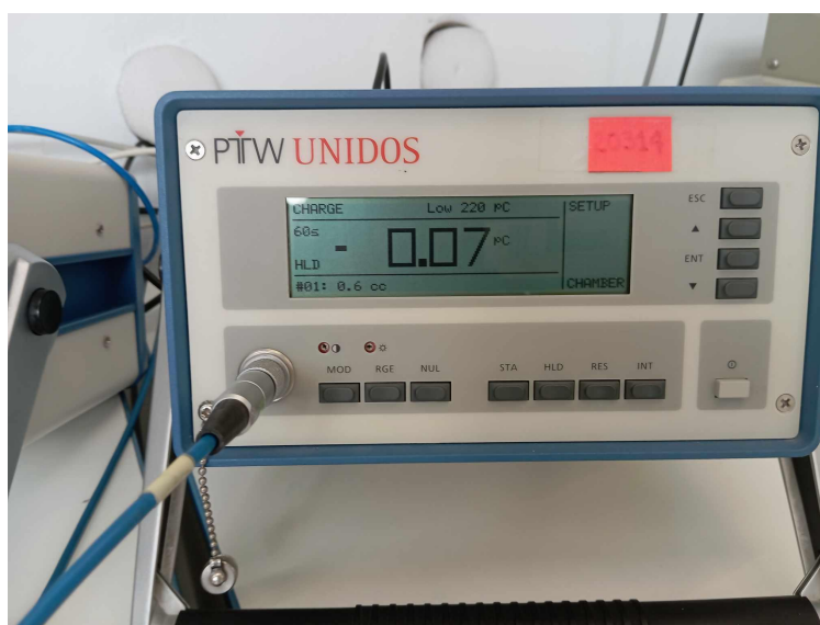
Εικόνα 4.6: Ηλεκτρόμετρο PTW-UNIDOS E.
