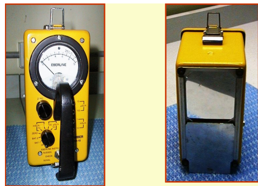
Εικόνα 3.12: Θάλαμος Ιονισμού Eberline Model R02 [14]
