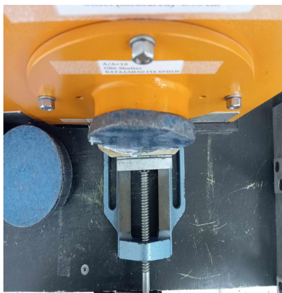
Εικόνα 4.17: Κάτοψη διάταξης με χρήση απορροφητή μολύβδου
