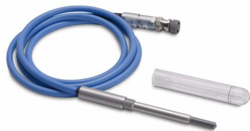
Εικόνα 3.14: Θάλαμος Ιονισμού Model 450 ασυμπέριστο [14]
