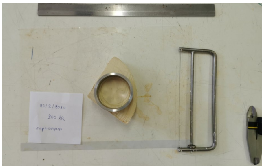
Φωτογραφία 4.4 Κομμάτι δοκιμίου, δακτύλιος δοκιμής και ειδική μεταλλική σέγα διαμόρφωσης του σχήματος του δοκιμίου.
