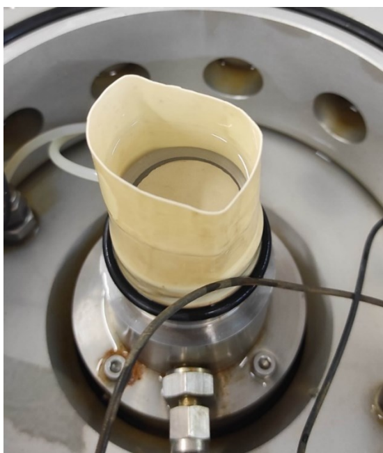
Φωτογραφία 4.17 Διατήρηση του κεραμικού πωρόλιθου πλήρως κορεσμένου
