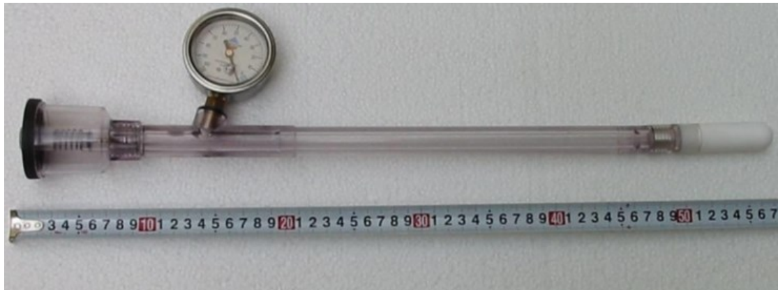
Φωτογραφία 2.5 Φωτογραφία τενσιόμετρου με πορώδες άκρο χαμηλής πίεσης αέρα (πηγή: Μπαρδάνης, 2016)
