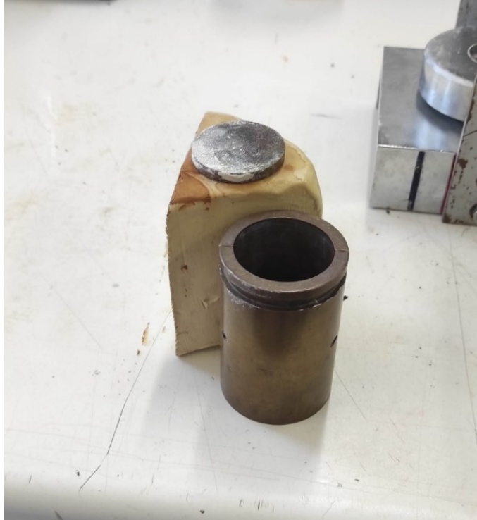
Φωτογραφία 4.14 Παρασκευή δοκιμίου – σύγκριση με το πρότυπο καλούπι (μεταλλικός κύλινδρος)
