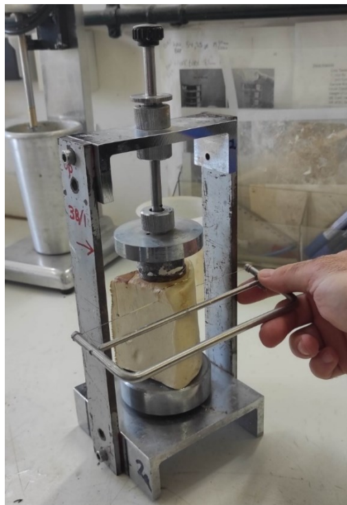
Φωτογραφία 4.14 Παρασκευή δοκιμίου – σύγκριση με το πρότυπο καλούπι (μεταλλικός κύλινδρος)
