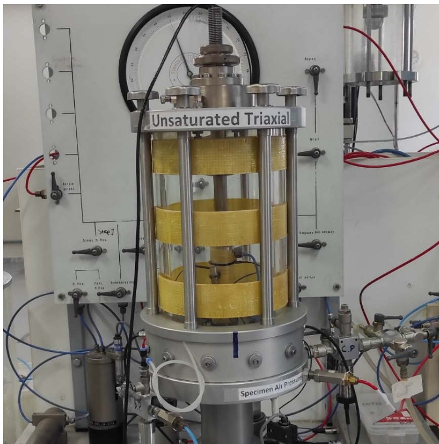
Φωτογραφία 4.22 Τοποθέτηση κυψέλης τριαξονικής συσκευής
