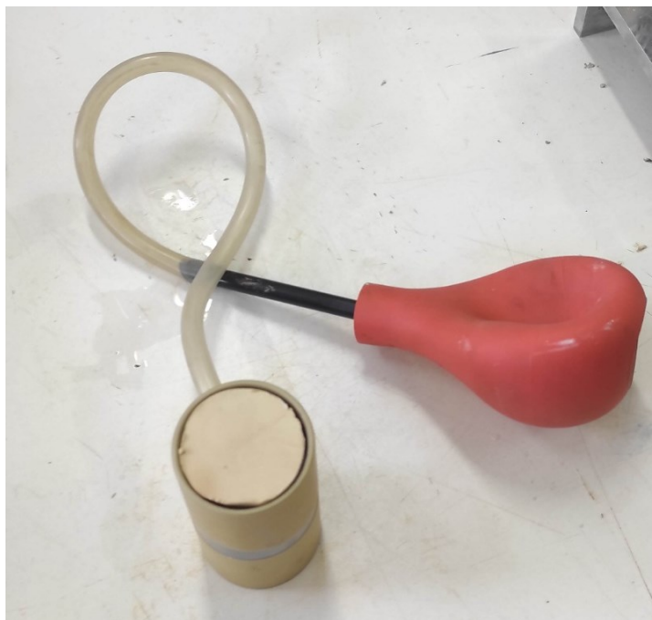
Φωτογραφία 4.16 Τοποθέτηση του δοκιμίου εντός μεμβράνης
