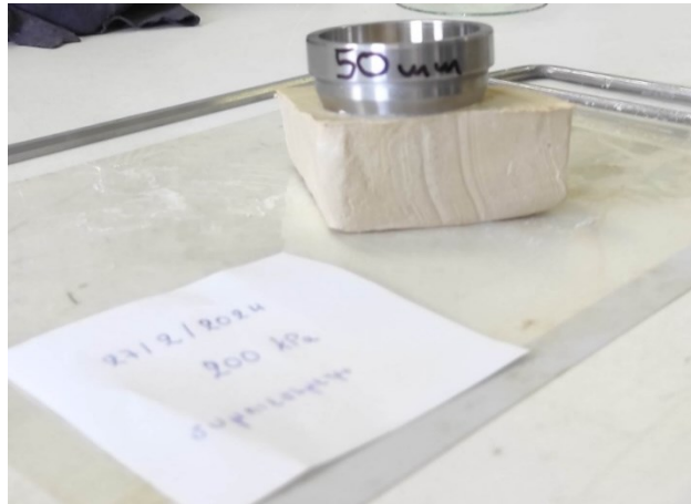
Φωτογραφία 4.5 Κομμάτι δοκιμίου, δακτύλιος δοκιμής και ειδική μεταλλική σέγα διαμόρφωσης του σχήματος του δοκιμίου
