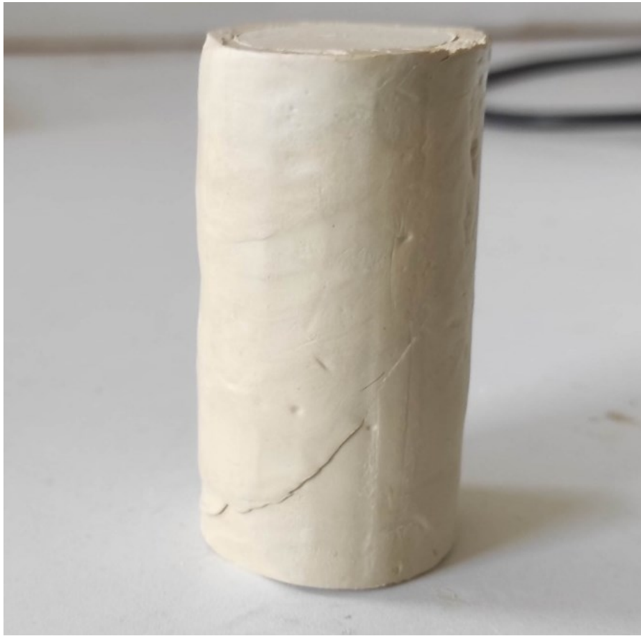
Φωτογραφία 4.23 Δοκίμιο με εμφανή επιφάνεια αστοχίας
