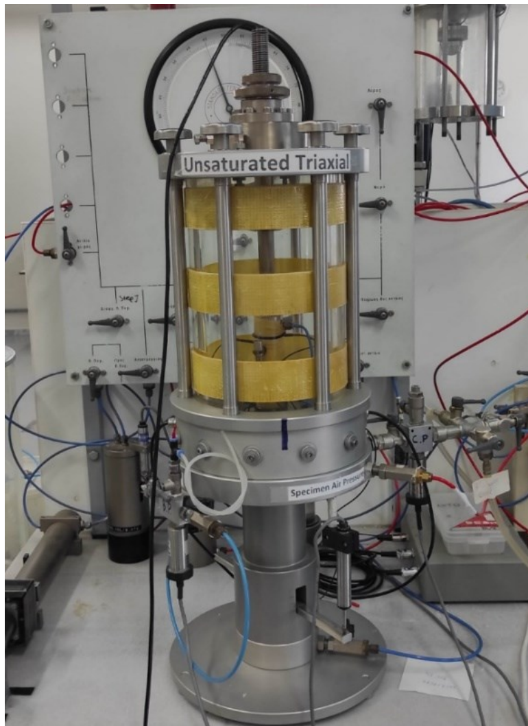
Φωτογραφία 4.9 Συσκευή τριαξονικής δοκιμής ακόρεστων εδαφών του εργαστηρίου Εδαφομηχανικής ΕΜΠ
