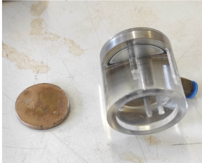
Φωτογραφία 4.12 Κεφαλή επιβολής πίεσης αέρα στους πώρους του δοκιμίου και μεταλλικός δίσκος από κορούνδιο
