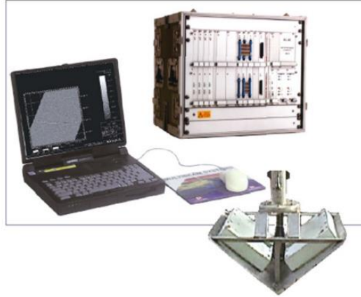
Σχ. 3.5 Πολυδραστικός ηχοβολιστής διπλής συχνότητας, Bottom Chart 1180/1050D, [Wu, 2021] Fig. 3.5 Dual-frequency MBES, Elac Bottom Chart 1180/1050D, [Wu, 2021]
