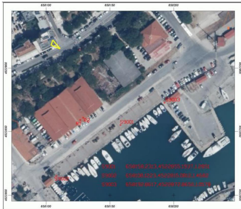
Σχ. 7.6 Γεωδαιτικά σημεία αναφοράς της αποτύπωσης των τοπογραφικών λεπτομερειών, [METRICA] Fig. 7.6 Geodetic reference points of the survey of topographic details, [METRICA]
