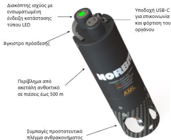
Σχ. 6.2 Βασικά μέρη του AML-3-LGR, [Norbit, 2021] Fig. 6.2 Main parts of AML-3-LGR, [Norbit, 2021]
