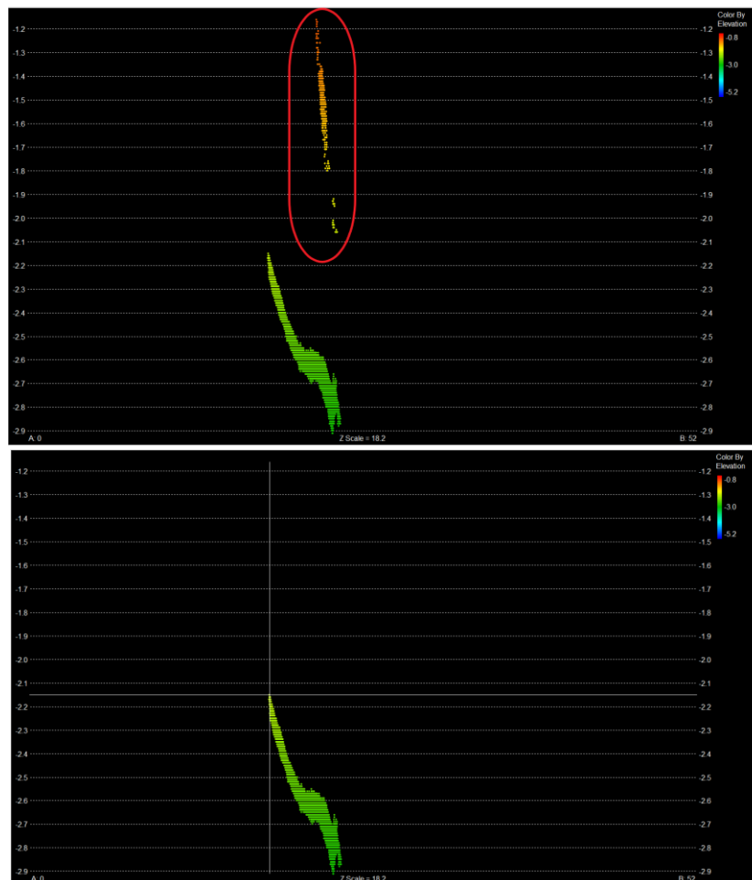
Σχ. 8.7 Παράδειγμα εξάλειψης θορύβου εντός HYPACK
