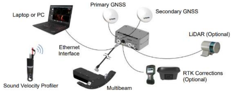
Σχ. 6.7 Γενική άποψη και διασύνδεση του εξοπλισμού υδρογραφικής αποτύπωσης, [NORBIT user manual, 2021] Fig. 6.7 General view and Interconnection of hydrographic survey equipment, [NORBIT user manual, 2021]
