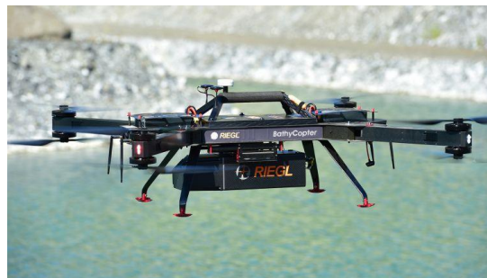
Σχ. 3.9 Μη επανδρωμένο εναέριο σύστημα αποτύπωσης της εταιρίας RIEGL ( BathyCopter ), [RIEGLE, 2018] Fig. 3.9 RIEGL's unmanned aerial mapping system ( BathyCopter ), [RIEGLE, 2018]
