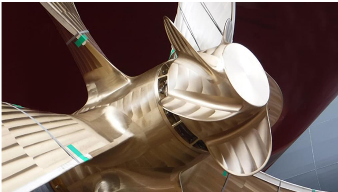
Εικόνα 1. Προπέλα πλοίου μαζί με το σύστημα PBCF της εταιρίας MOL Techno[4]
