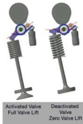
Σχήμα 2.1: Εναλλασσόμενος Ωστήριος Μοχλός με Τροχίσκο στις δύο καταστάσεις λειτουργίας[15].
