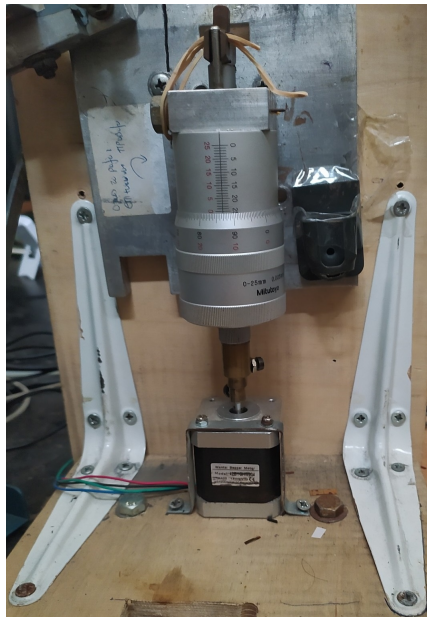
Σχήμα 4.2: Μικρόμετρο (βερνιέρος) με προσαρτημένο χάλκινο μεταλλικό πρόβολο στερεωμένο σε ξύλινη βάση
