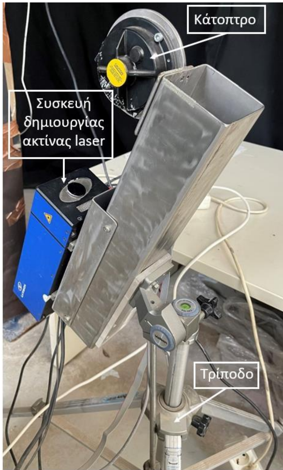
Εικόνα 11. Η συσκευή ακτίνας laser της τεχνικής LIF (Σολωμού 2022)
