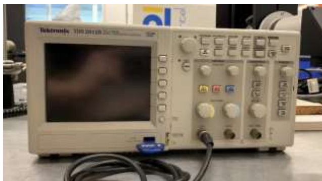
Εικόνα 31: Ο παλμογράφος Tektronix TDS2012B
