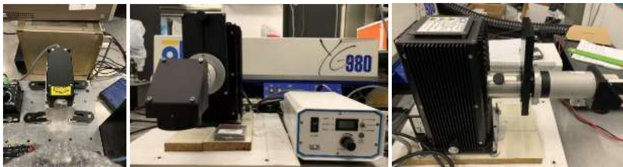
Εικόνα 28: Το laser υπέρυθρης ακτινοβολίας 1064 nm (αριστερά), η πρόσοψη και η μονάδα ελέγχου του ηλιακού προσομοιωτή (στο κέντρο), η πλάγια όψη του ηλιακού προσομοιωτή (δεξιά).
