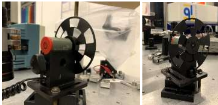
Εικόνα 30: Ο Chopper που χρησιμοποιήθηκε για την μετατροπή της συνεχούς ακτινοβολίας σε παλμική
