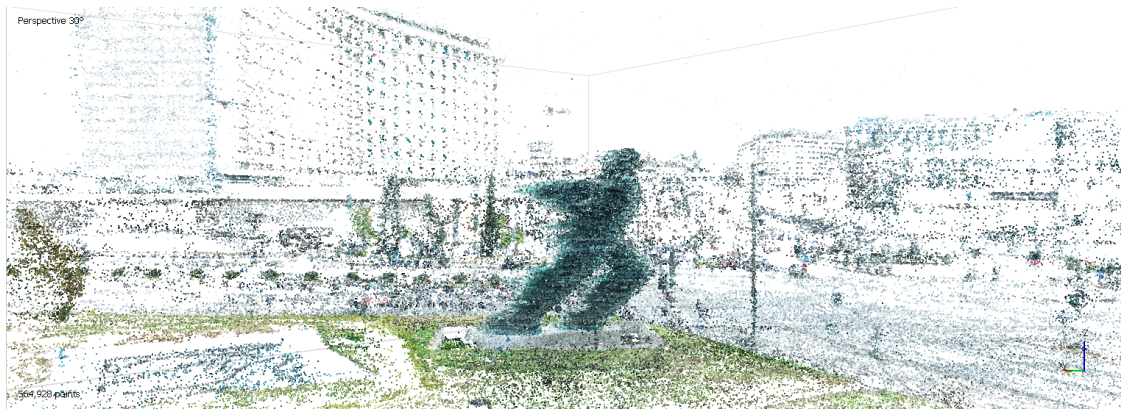
Σχήμα 3.23. Απεικόνιση του τριδιάστατου αραιού νέφους σημείων από την ευθυγράμμιση των εικόνων για όλη τη σκηνή που απεικονίζουν οι εικόνες του Drone (II) στο περιβάλλον Agisoft Metashape (Pro).
