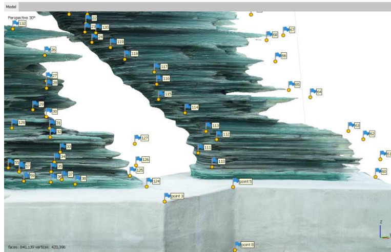
Σχήμα 3.58. Απεικόνιση (II) ενδεικτικών αιωρούμενων φωτοσταθερών σημείων σε θέσεις όπου θα έπρεπε να έχουν αποδοθεί λεπτές γυάλινες πλάκες, στο περιβάλλον Agisoft Metashape (Pro).
