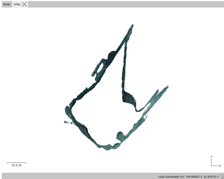
Σχήμα 4.7. Απεικόνιση ορθομωσαϊκού για την επιφάνεια του επιπέδου η οποία διέρχεται από το τμήμα της μέσης στο τριδιάστατο μοντέλο του Δρομέα, σε περιβάλλον Agisoft Metashape (Pro).
