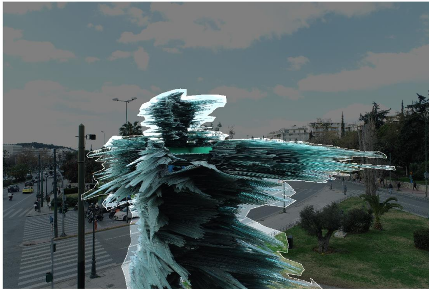
Σχήμα 3.51. Τοποθέτηση μάσκας αυθαίρετα περιμετρικά του γλυπτού, με έμφαση στην απόκλιση της πληροφορίας που δεν έχει άμεση σχέση με το γλυπτό στο περιβάλλον Agisoft Metashape (Pro).
