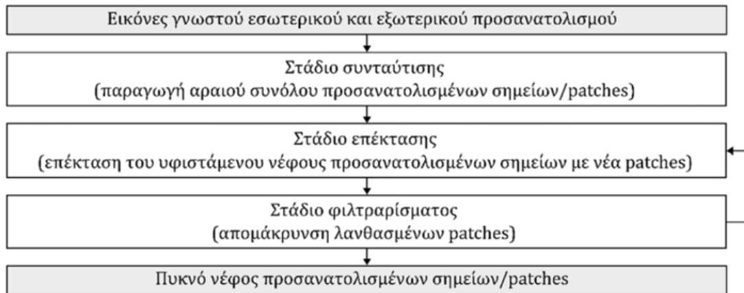
Σχήμα 2.7. Διάγραμμα ροής της μεθόδου πύκνωσης αραιού νέφους σημείων PMVS [13].
