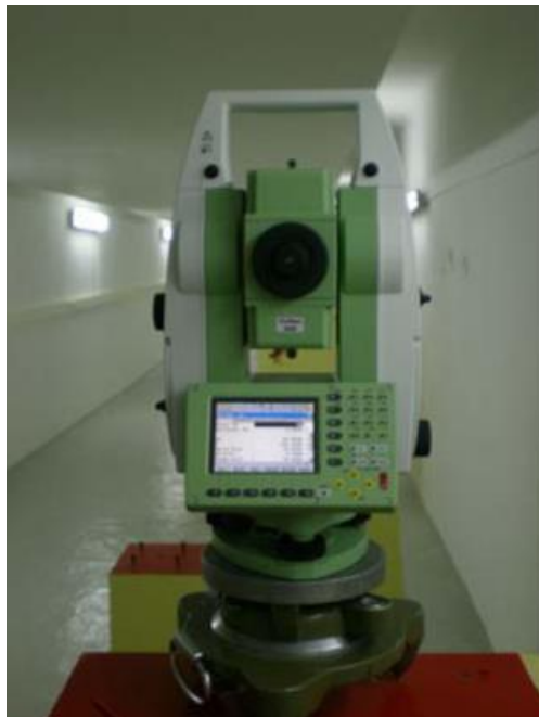
Εικόνα 3.2. Ολοκληρωμένος γεωδαιτικός σταθμός Leica TCRM 1201+ [9].
