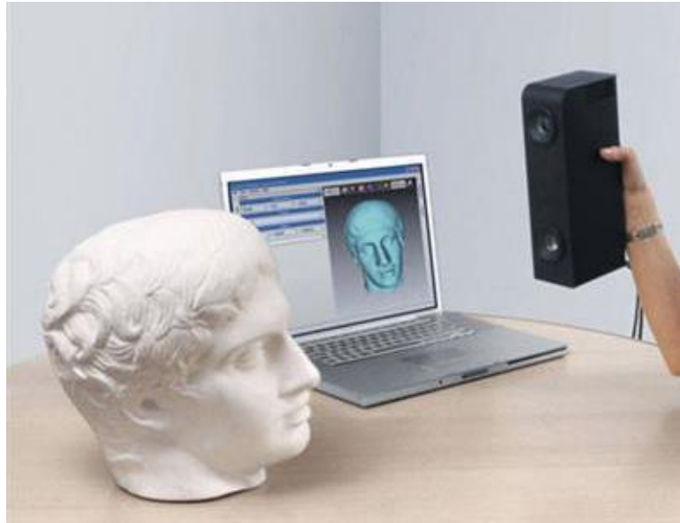
Εικόνα 2.2. Απεικόνιση ανιχνευτή με αισθητήρες που δεν έρχονται σε επαφή με το αντικείμενο (non-contact method) [69].
