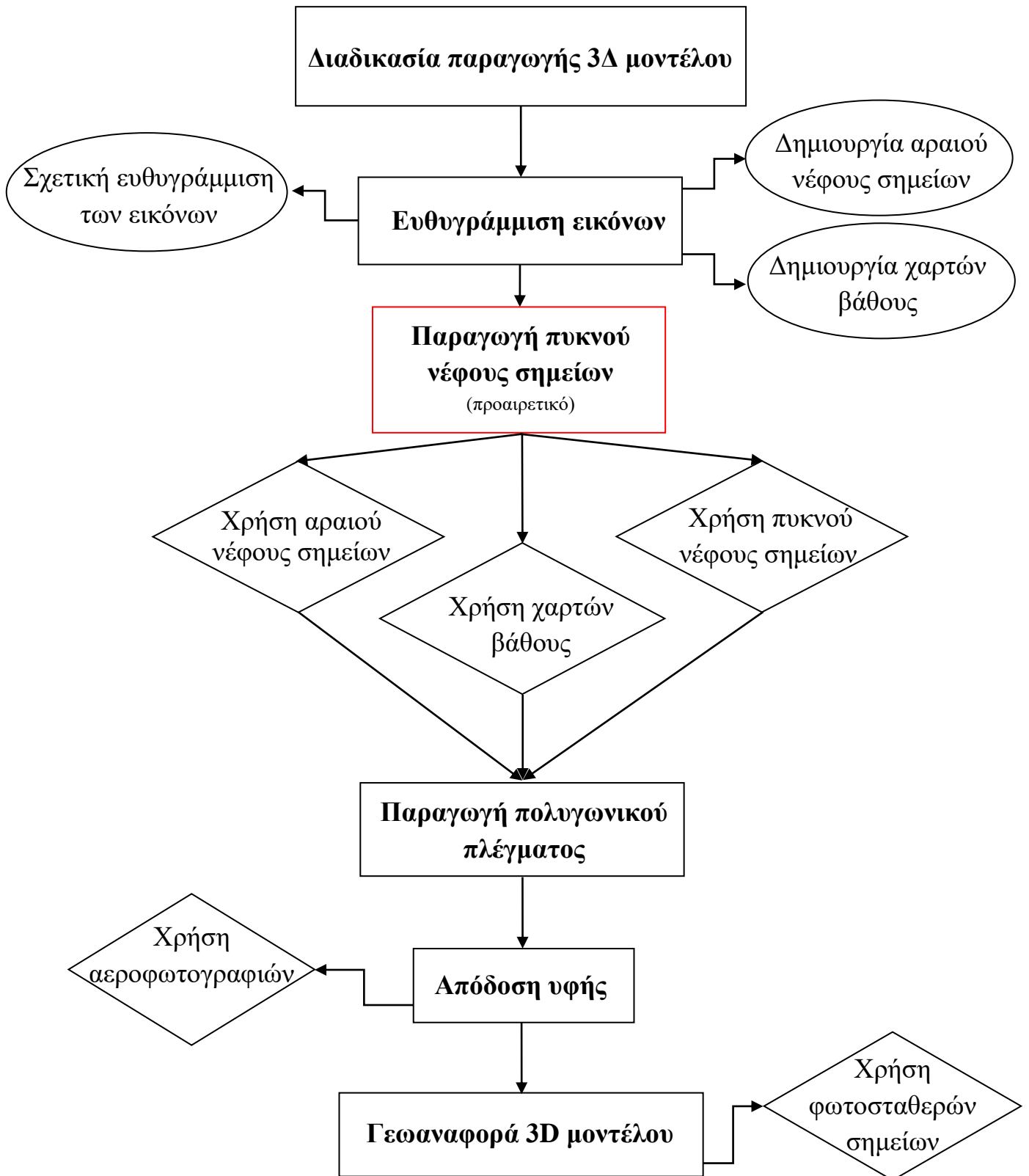
Διάγραμμα 6.2. Διάγραμμα ροής παραγωγής 3D μοντέλου στο λογισμικό Metashape της εταιρείας Agisoft.
