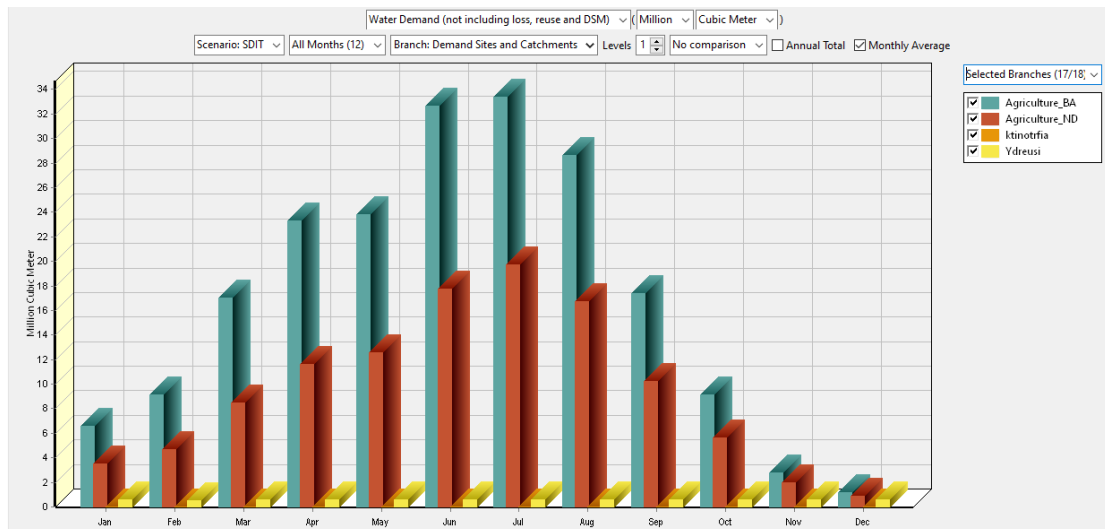
Σχήμα 25: Μηνιαίες τιμές απολήψεων ανά χρήση γης για το σενάριο του νέου αρδευτικού έργου (μπλε – BA καλλιέργειες, κόκκινο – ND καλλιέργειες, πορτοκαλί – κτηνοτροφία, κίτρινο – ύδρευση)
