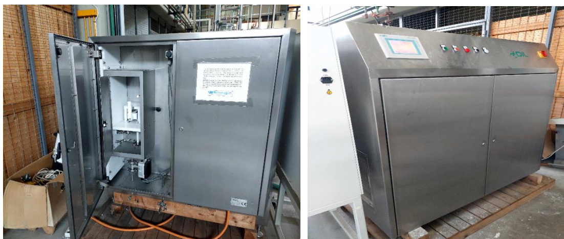
Εικόνα 4.7: Η μονάδα επεξεργασίας ΠΗΠ ELCRACK-5kW του Εργαστηρίου Χημείας και Τεχνολογίας Τροφίμων της Σχολής Χημικών Μηχανικών ΕΜΠ
