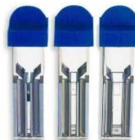
Εικόνα 4.6: Κυψελίδες ηλεκτροδιάτρησης απόστασης ηλεκτροδίων 0.2-1 cm
