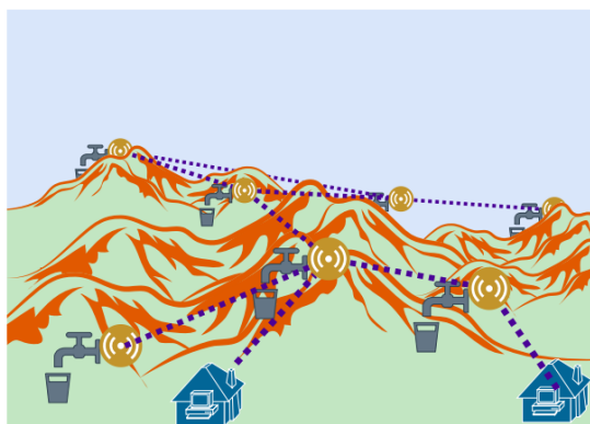
Σχήμα 3.9: Ανάπτυξη δικτύου Mesh χωρίς υποδομή LoRaWAN [13]
