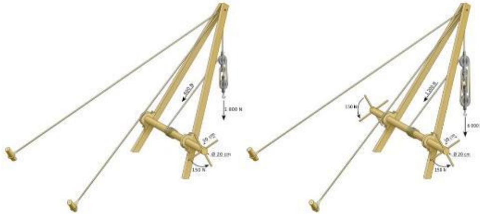
Εικόνα 1.3 Γραφική αναπαράσταση τρισπάστου και πεντασπάστου με ανάλυση των ανυψωτικών δυνάμεων [Πηγή: Eric Gaba – Wikimedia Commons]
