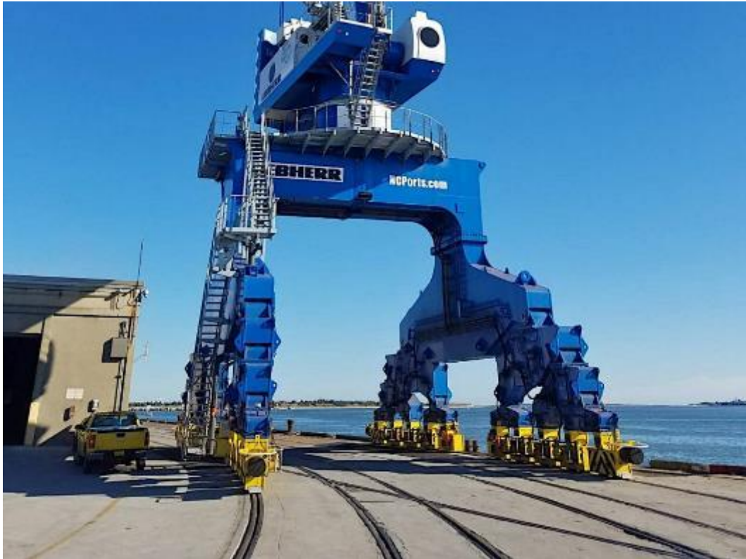
Εικόνα 1.34 Γερανογέφυρα που κινείται σε καμπύλο τμήμα με διακλαδώσεις στο λιμάνι του Morehead City στην Νότια Καρολίνα, ΗΠΑ (Πηγή: Liebherr)
