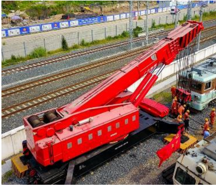
Εικόνα 1.23 Σιδηροδρομικός γερανός κατά την διάρκεια εντροχιασμού συρμού [Πηγή: Sinotrailers]
