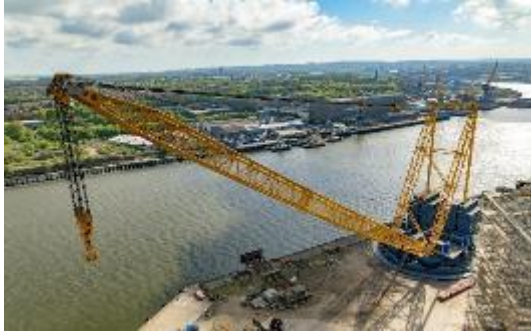
Εικόνα 1.13 Γερανός δακτυλίου της εταιρείας Sarens [Πηγή: Sarens]
