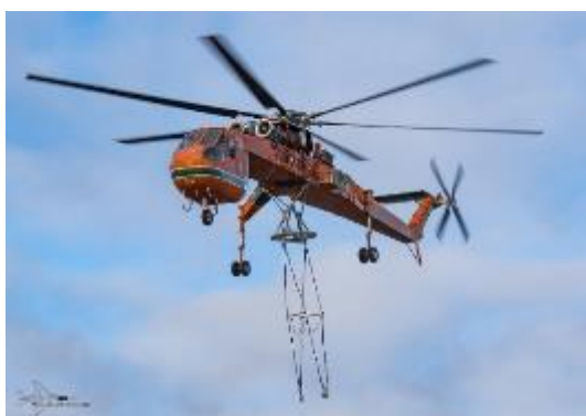
Εικόνα 1.26 Ένα Erickson S-64 Aircrane, το πιο συνηθισμένο ελικόπτερο τέτοιου τύπου [Πηγή: Martyn Wraight – Flickr]
