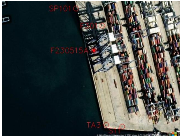
Εικόνα 4.11 Σκαρίφημα της ελεύθερης στάσης και των γνωστών σημείων που χρησιμοποιήθηκαν για τον προσδιορισμό της θέσης της
