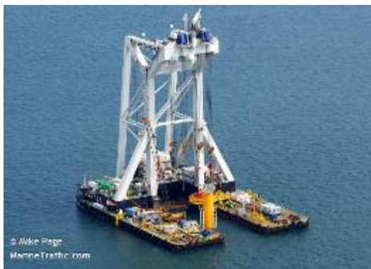
Εικόνα 1.25 Πλωτός γερανός τύπου καταμαράν [Πηγή: Marinetrassic]
