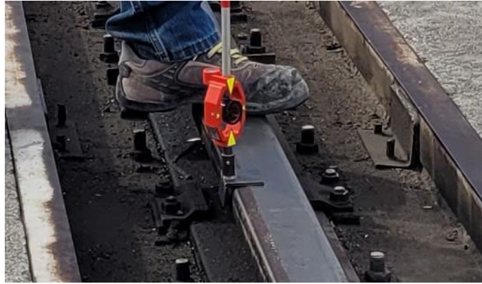
Εικόνα 3.4 Η γωνιά και το κατάφωτο το οποίο χρησιμοποιείται για την μέτρηση της γραμμής
