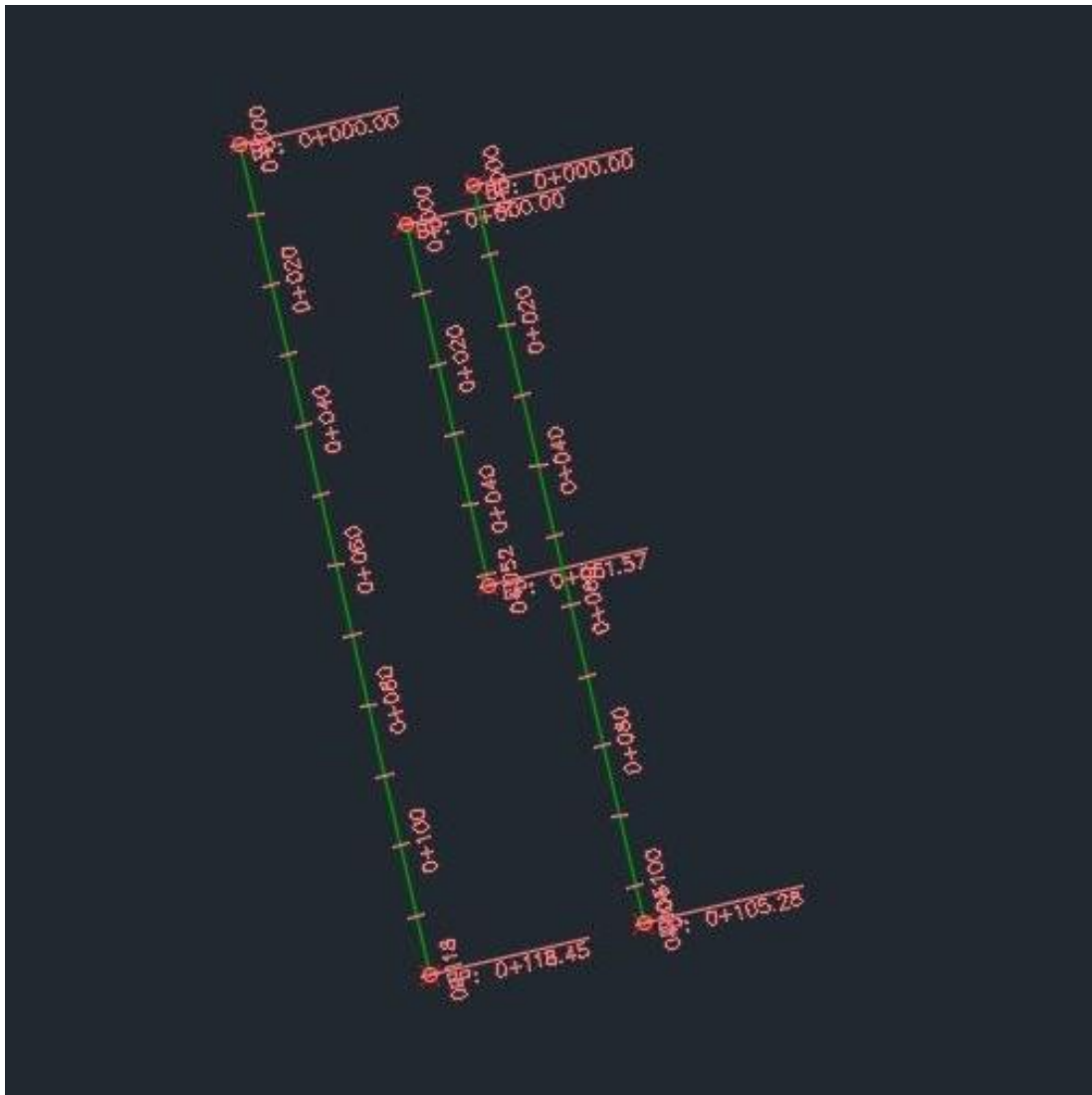
Εικόνα 4.4 Σκαρίφημα του άξονα των τριών σιδηροτροχιών που βρίσκονται στο Pier II
