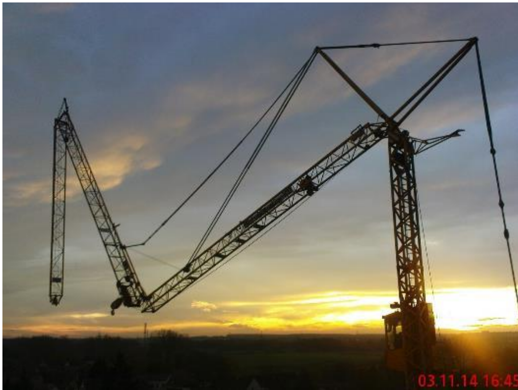
Εικόνα 1.17 Αυτοανεγειρόμενος γερανός στην Γερμανία [Πηγή: Phr En – Wikimedia Commons]
