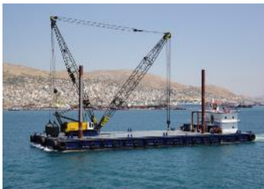
Εικόνα 1.24 Περιστρεφόμενος πλωτός γερανός [Πηγή: Sranopoulos Group]
