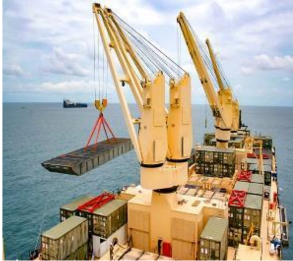
Εικόνα 1.18 Συστοιχία γερανών σε πλοίο μεταφοράς κοντέινερ [Πηγή: Weihua]
