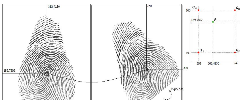
Σχήμα 3.21 Παράδειγμα διγραμμικής παρεμβολής στα δακτυλικά αποτυπώματα
