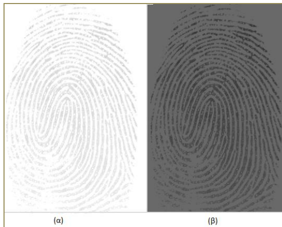
Σχήμα 3.4 (α) Αρχική εικόνα δακτυλικού αποτυπώματος. (β) Βελτιωμένη εικόνα
