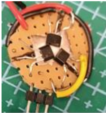
ΕΙΚΟΝΑ 42: ΑΙΣΘΗΤΗΡΙΟ ΣΤΟΙΧΕΙΟ (3 ΑΙΣΘΗΤΗΡΕΣ HALL) ΣΤΟ ΚΑΤΩ ΜΕΡΟΣ ΤΗΣ ΔΙΑΤΑΞΗΣ.
