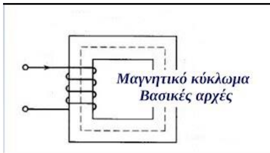
ΕΙΚΟΝΑ 14: ΕΝΑ ΜΑΓΝΗΤΙΚΟ ΚΥΚΛΩΜΑ ΑΠΟΤΕΛΟΥΜΕΝΟ ΑΠΟ ΜΙΑ ΠΗΓΗ ΜΑΓΝΗΤΙΚΟΥ ΠΕΔΙΟΥ(ΑΓΩΓΟΣ ΚΑΙ ΗΛΕΚΤΡΙΚΟ ΡΕΥΜΑ), ΔΗΛΑΔΗ ΠΗΝΙΟ ΚΑΙ ΕΝΑ ΜΑΓΝΗΤΙΚΟ ΥΛΙΚΟ.
