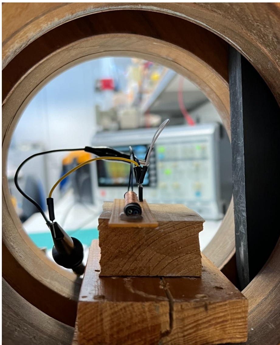
Εικόνα 57: Ο race-track αισθητήρας fluxgate εντός του πηνίου Helmholtz
