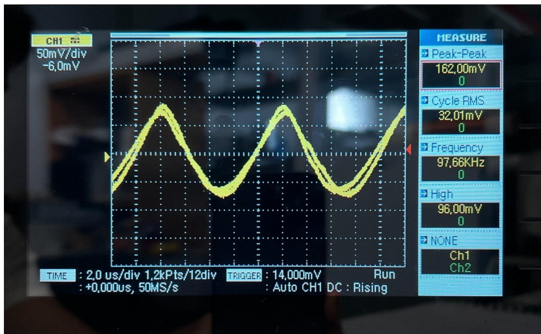
Εικόνα 65: Κυματομορφή τάσης εξόδου V_{pp} του αισθητήρα, με συχνότητα διέγερσης 100 kHz, χωρίς την παρουσία εξωτερικού μαγνητικού πεδίου
