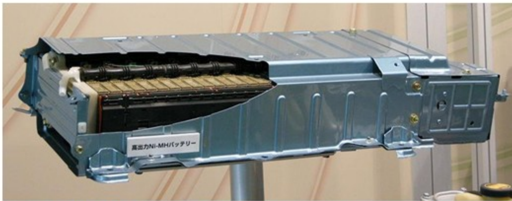
Σχήμα 5.14 Μία συστοιχία μπαταριών από το Toyota Prius
