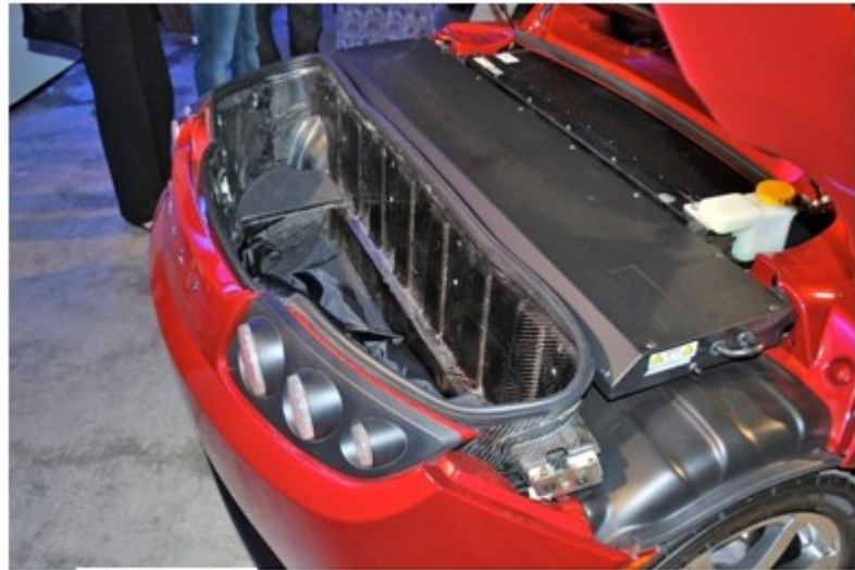
Σχήμα 5.12 Οι συστοιχίες μπαταριών του Tesla Roadster στο πίσω μέρος του οχήματος
