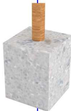
μπετονένιο πέδιλο για την πάκτωση του πασαλού, στο έδαφος 40x40x50εκ
