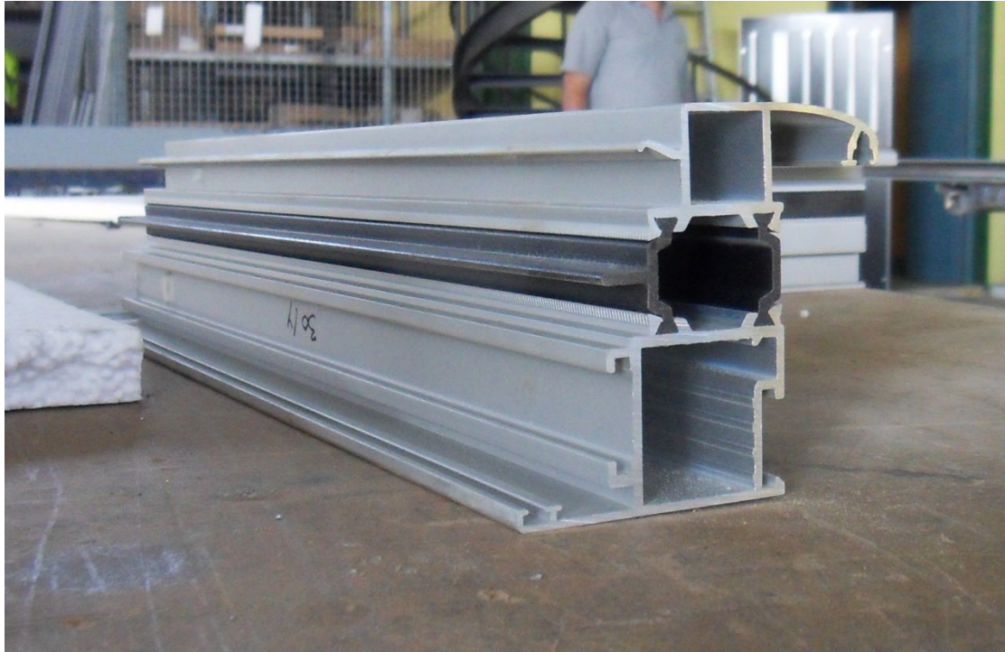
Εικόνα 2.28: Προφίλ αλουμινίου με θερμοδιακοπή από πολυαμίδιο.
