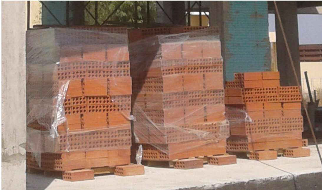
Εικόνα 2.5: Το τυπικό Κυπριακό τούβλο διαστάσεων 10 X 20 X 30 εκ.
