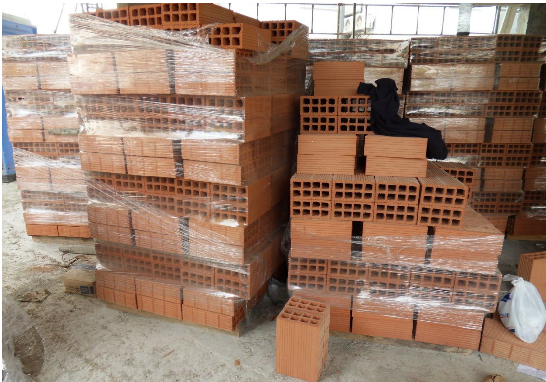
Εικόνα 4.20: Τυπικό Κυπριακό διάτρητο τούβλο διαστάσεων 10 X 20 X 30 εκατοστά.
