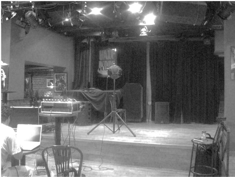
Διεξαγωγή φυσικών ακουστικών μετρήσεων στο Half Note
