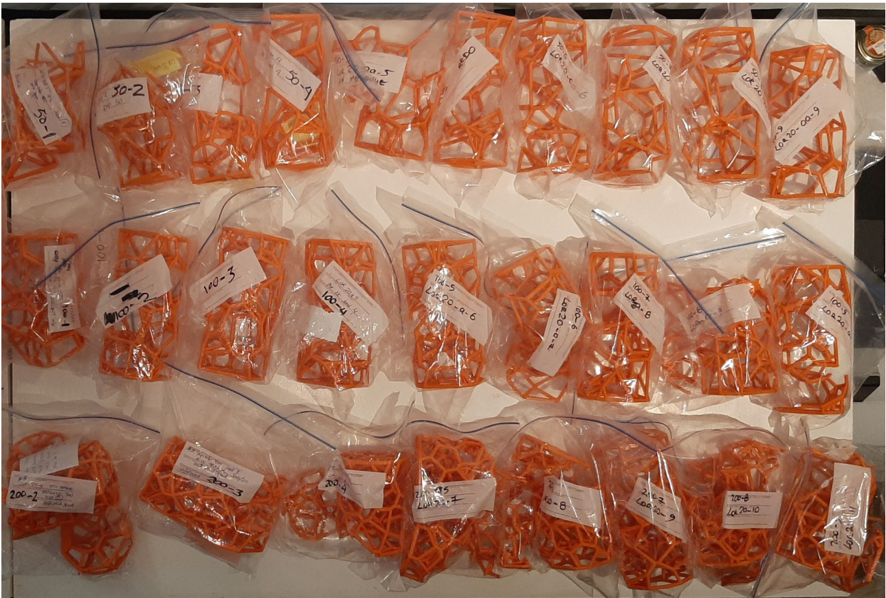
Εικόνα 8_131: Ραβδωτά δοκίμια μετά τις δοκιμές σε θλίψη και πριν την εξέταση των αστοχιών τους. Πηγή: Τ. Κουιμτζόγλου.
