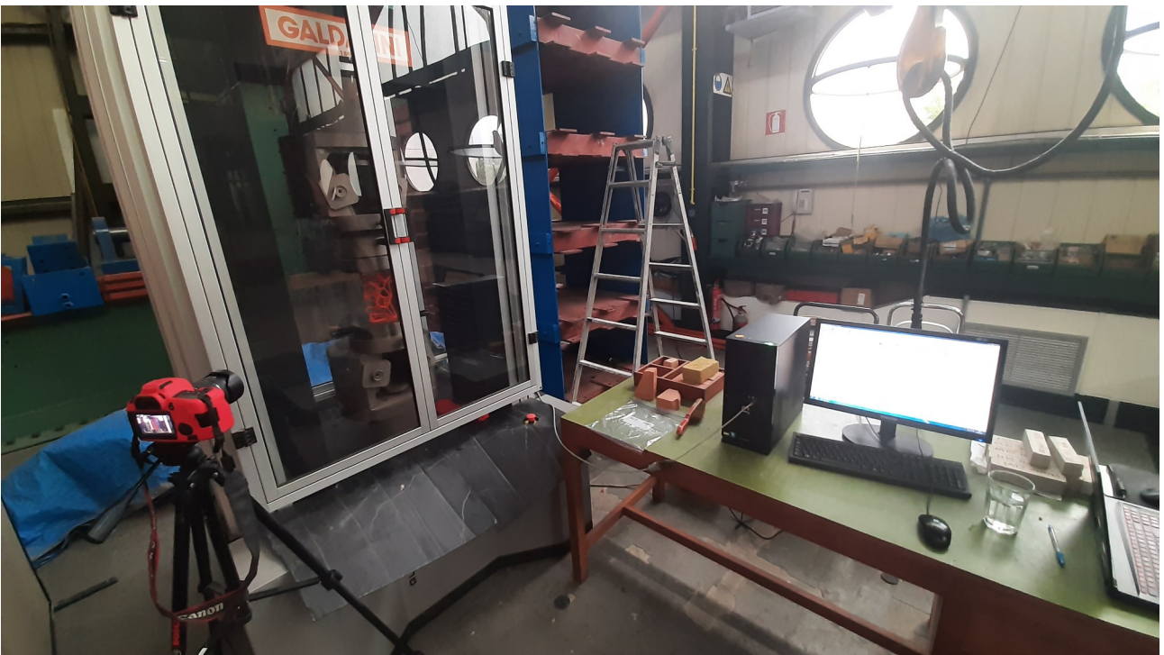
Εικόνα 8_86: Πειραματική διάταξη μηχανής Galdabini του Εργαστηρίου Τεχνικών Υλικών της Σχολής Αρχιτεκτόνων Μηχανικών ΕΜΠ, στο Εργαστήριο Αντισεισμικής Τεχνολογίας της Σχολής Πολιτικών Μηχανικών ΕΜΠ. Διακρίνεται κατά τη διεξαγωγή πειράματος: η μηχανή φόρτισης, ο συνδεδεμένος υπολογιστής καταγραφής δεδομένων και η camera καταγραφής video. Πηγή: Τ. Κουμιτζόγλου.
