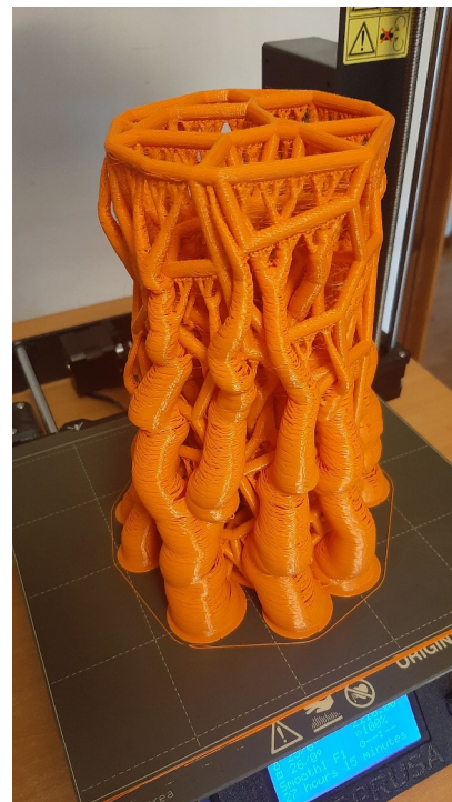
Εικόνα 8_68: 3d εκτυπωτής PRUSA MK3S με MMU2S ραβδωτού δοκιμίου από Πορτοκαλί PETG πριν την αφαίρεση των ικριωμάτων τύπου organic supports. Πηγή: Τ. Κουμτζόγλου.
