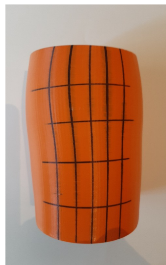
Εικόνα 8_138: Συμπαγές δοκίμιο Sor20-2 μετά τη δοκιμή σε αντοχή σε θλίψη. Πηγή: Τ. Κουιμτζόγλου.
