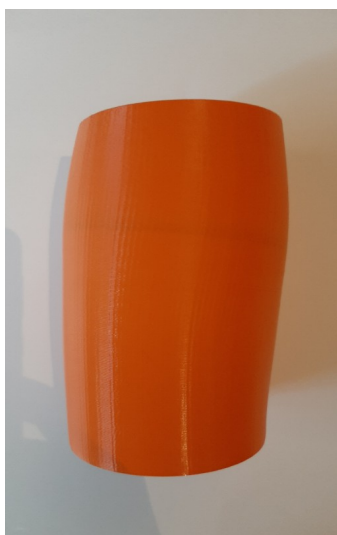
Εικόνα 8_137: Συμπαγές δοκίμιο Sor20-1 μετά τη δοκιμή σε αντοχή σε θλίψη. Πηγή: Τ. Κουιμτζόγλου.
