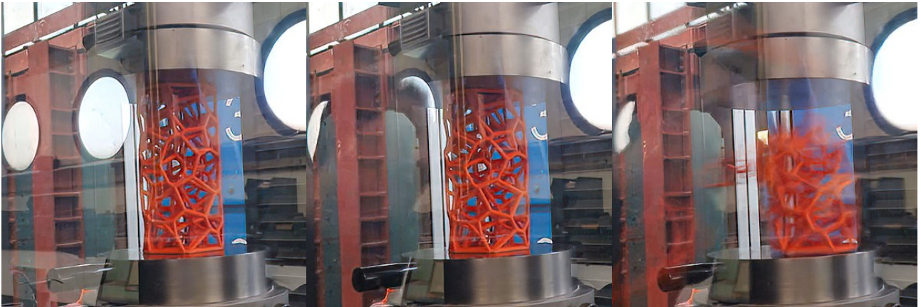
Εικόνα 8_107: Δοκίμιο 200-1. Πριν τη φόρτιση (αριστερά), κατά την εμφάνιση των αρχικών τοπικών αστοχιών (κέντρο), μετά την καθολική αστοχία (δεξιά). Πηγή: Τ. Κουιμτζόγλου.
