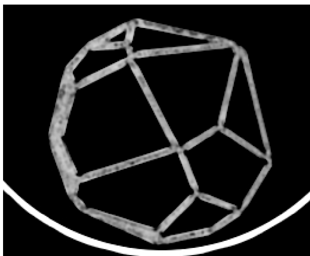
Εικόνα 8_82: Αριστερά: Τομή αξονικού τομογράφου στη βάση του δικτυωματικού δοκιμαστικού δοκίμιου. Παρατηρούνται διαφοροποιήσεις στην πυκνότητα των στοιχείων των ράβδων οι οποίες υποδηλώνουν ότι οι περιοχές γεμίσματος (infill) της 3d εκτύπωσης για τις συγκεκριμένες διαστάσεις δεν είναι εντελώς ομοιογενείς. Δεξιά: Μεγέθυνση περιοχής. Πηγή: Τ. Κουιμτζόγλου.
