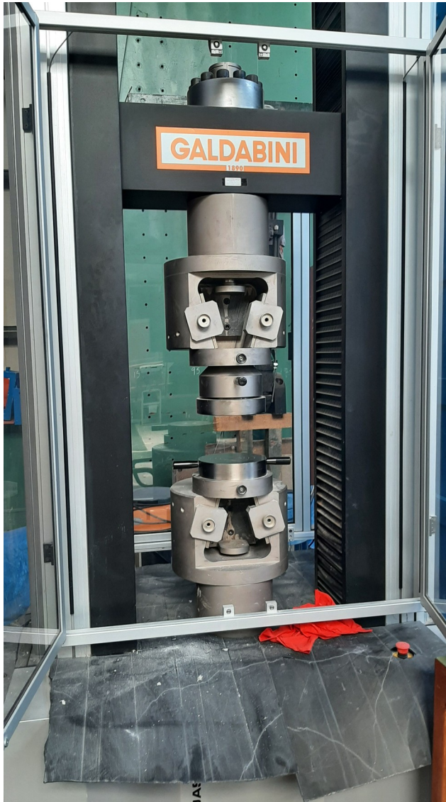
Εικόνα 8_83: Γενική άποψη της μηχανής Galdabini. Διακρίνεται το υδραυλικό έμβολο και η περιοχή τοποθέτησης των δοκιμίων. Πηγή: Τ. Κουιμτζόγλου.
