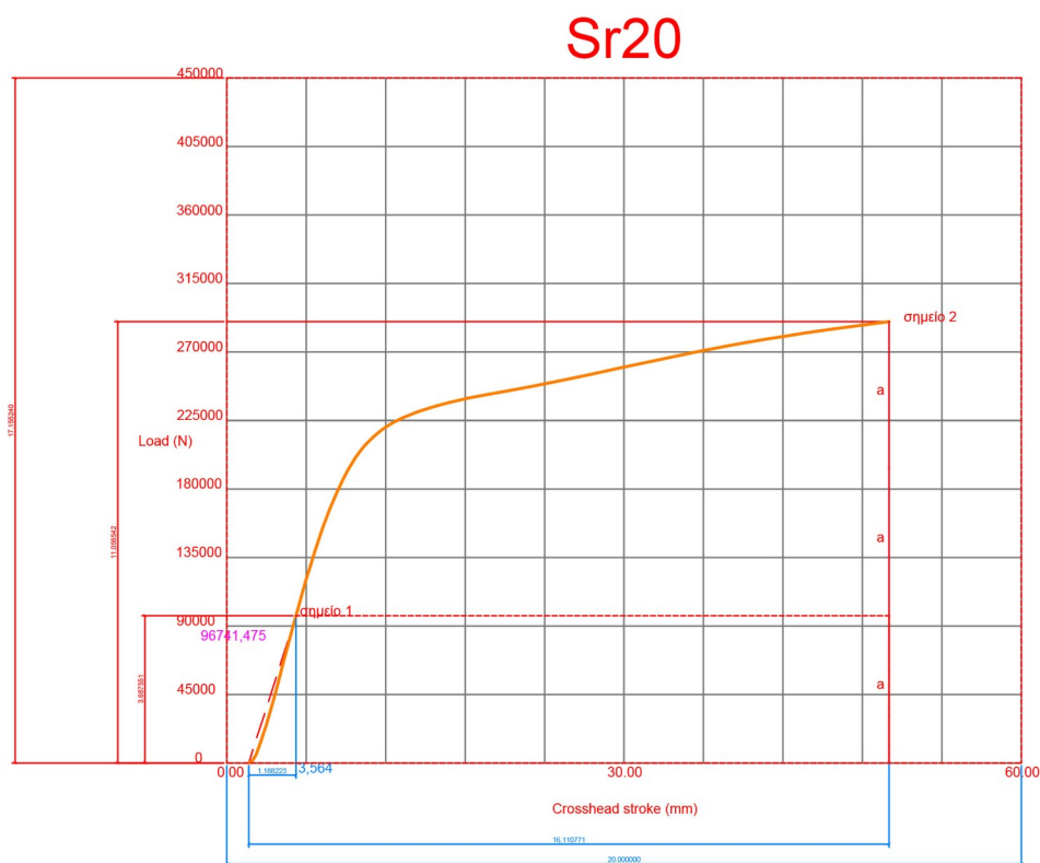
Εικόνα 8_140: Διάγραμμα φόρτισης συμπαγούς κυλινδρικού δοκιμίου διαμέτρου 10cm και ύψους 20cm. Δοκίμιο Sr20. Πηγή: Τ. Κουμτζόγλου.
