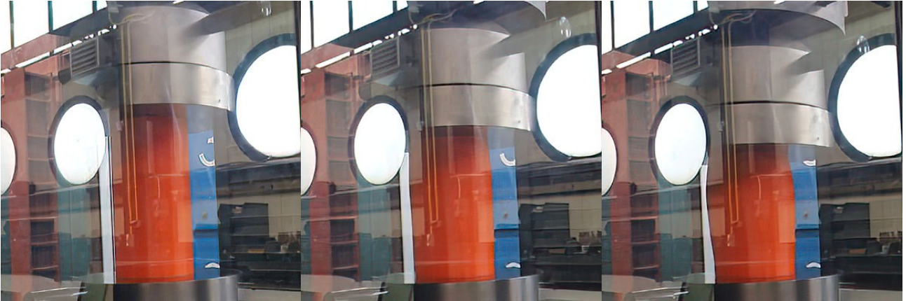
Εικόνα 8_116: Δοκίμιο Sr20. Πριν τη φόρτιση (αριστερά), φόρτιση με μετατόπιση κεφαλής ~25mm (κέντρο), φόρτιση με κάθοδο κεφαλής ~50mm (δεξιά). Πηγή: Τ. Κουιμτζόγλου.
