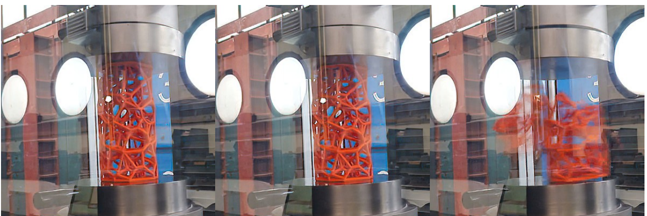
Εικόνα 8_109: Δοκίμιο 200-3. Πριν τη φόρτιση (αριστερά), κατά την εμφάνιση των αρχικών τοπικών αστοχιών (κέντρο), μετά την καθολική αστοχία (δεξιά). Πηγή: Τ. Κουιμτζόγλου.
