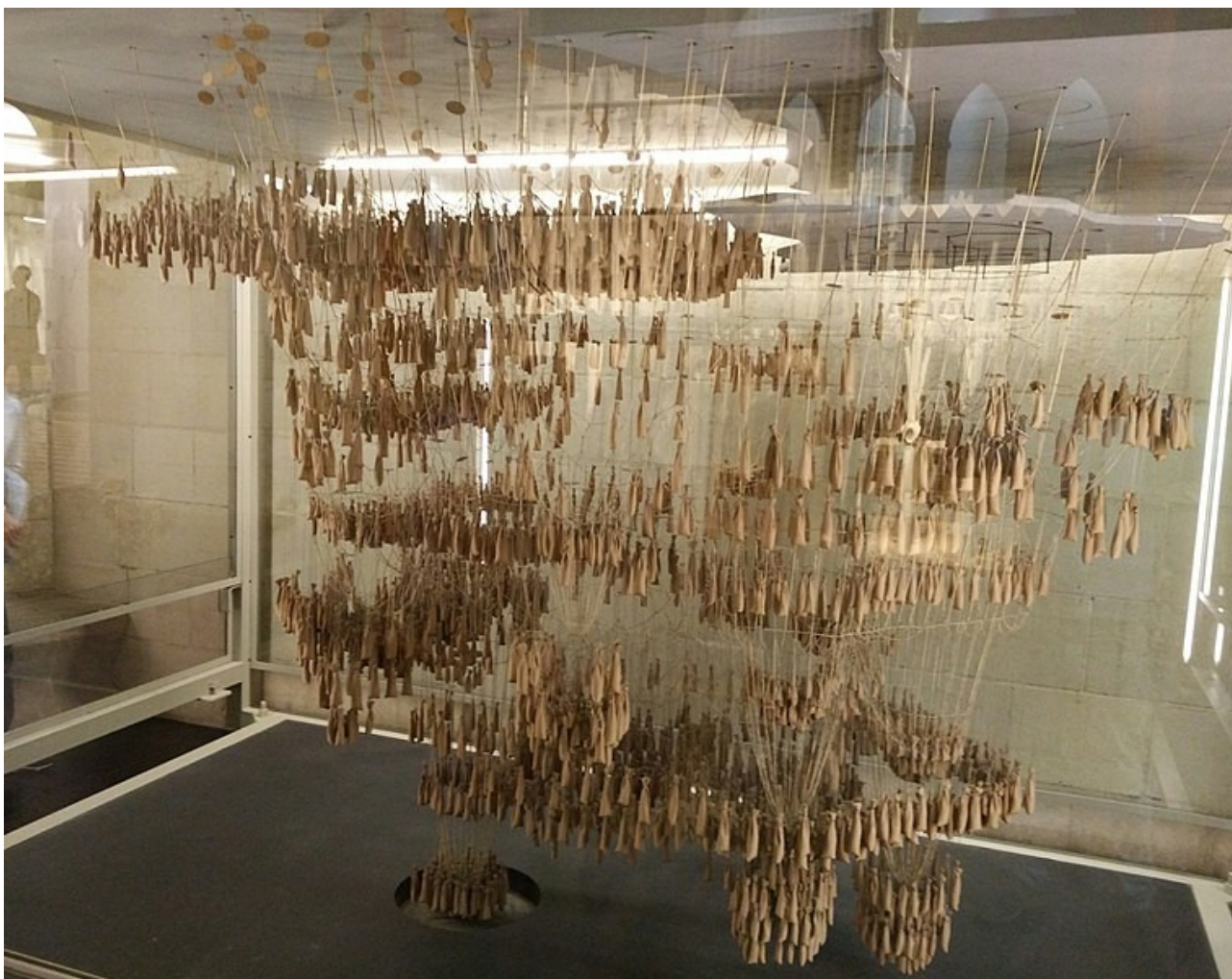
Εικόνα 6_11: Μοντέλο στατικής διερεύνησης του A. Gaudí για τη Sagrada Família. Πηγή: Maqueta funicular de la iglesia de la colonia Güell usada por Gaudí.jpg, maqueta funicular de la iglesia de la colonia Güell usada por Gaudí actualmente expuesta en el Museo del templo de la Sagrada Família, https://commons.wikimedia.org/wiki/File:Maqueta_funicular_de_la_iglesia_de_la_colonia_G%C3%BCell_usada_por_Gaud%C3%AD.jpg , εικόνα του/της: Javiermes , άδεια: CC BY-SA 4.0, Creative Commons Attribution-Share Alike 4.0 International license. Δεν έχουν γίνει αλλαγές στο αρχείο.
