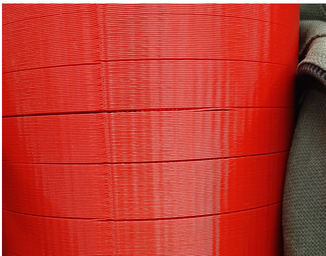
Εικόνα 8_80: Αποκολλήσεις στρώσεων στο συμπαγές δοκίμιο Sr20 από κόκκινο PETG μετά την ολοκλήρωση της εκτύπωσής του οι οποίες δεν παρουσιάστηκαν στα πορτοκαλί PETG δοκίμια με τις ίδιες ρυθμίσεις 3d εκτύπωσης. Πηγή: Τ. Κουιμτζόγλου.
