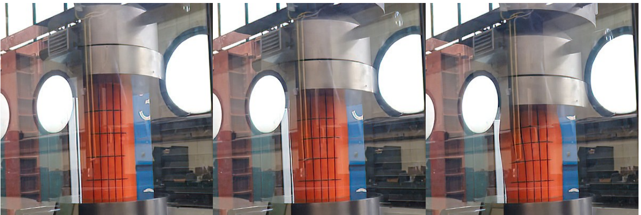
Εικόνα 8_117: Δοκίμιο Sor20-1. Πριν τη φόρτιση (αριστερά), φόρτιση με μετατόπιση κεφαλής ~25mm (κέντρο), φόρτιση με κάθοδο κεφαλής ~50mm (δεξιά). Πηγή: Τ. Κουιμτζόγλου.
