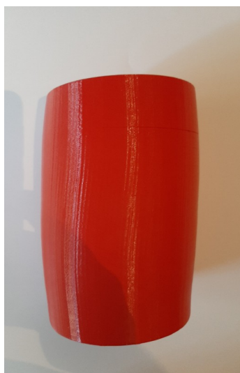
Εικόνα 8_136: Συμπαγές δοκίμιο Sr20 μετά τη δοκιμή σε αντοχή σε θλίψη. Πηγή: Τ. Κουιμτζόγλου.
