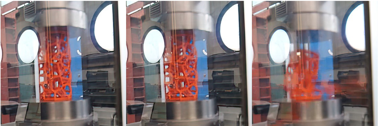
Εικόνα 8_110: Δοκίμιο 200-4. Πριν τη φόρτιση (αριστερά), κατά την εμφάνιση των αρχικών τοπικών αστοχιών (κέντρο), μετά την καθολική αστοχία (δεξιά). Πηγή: Τ. Κουιμτζόγλου.
