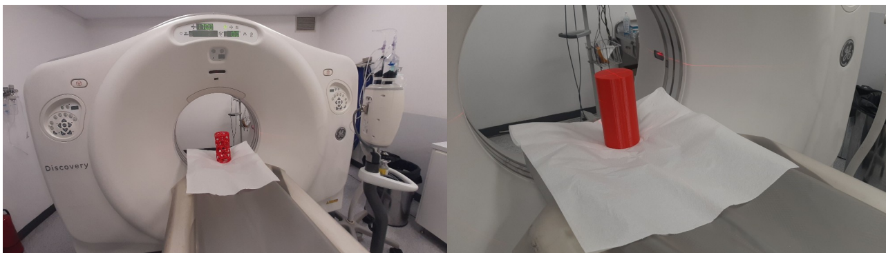
Εικόνα 8_77: Ραβδωτό και συμπαγές δοκίμιο σε έλεγχο με αξονικό τομογράφο. Πηγή: Τ. Κουιμτζόγλου.
