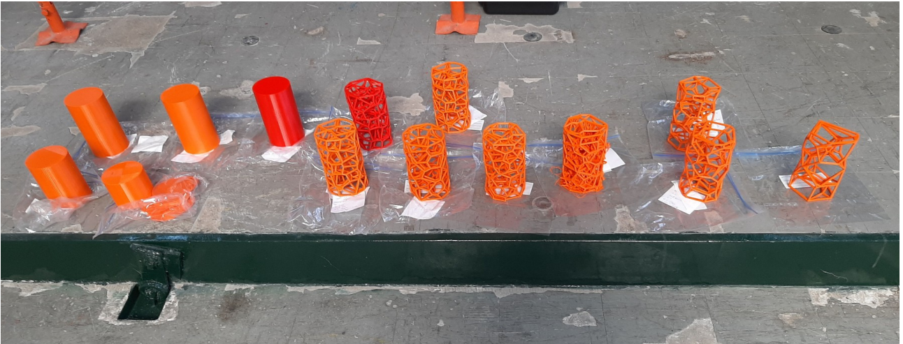
Εικόνα 8_85: Εργαστήριο αντισεισμικής τεχνολογίας ΕΜΠ. Πρώτη ομάδα πειραματικών ελέγχων. Δοκιμαστικά και κύρια συμπαγή και ραβδωτά δοκίμια πριν τους ελέγχους δοκιμών σε θλίψη στη μηχανή Galdabini. Πηγή: Τ. Κουμιτζόγλου.
