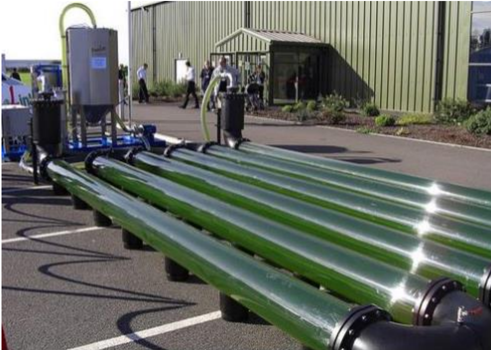
Εικόνα 3: Σύστημα κλειστών σωληνοειδών φωτοβιοαντιδραστήρων
