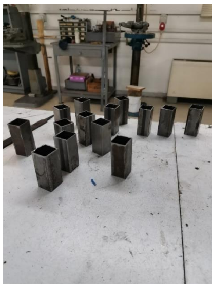
Εικόνα 4.1.1: Μεμονωμένα Δοκίμια Χάλυβα
