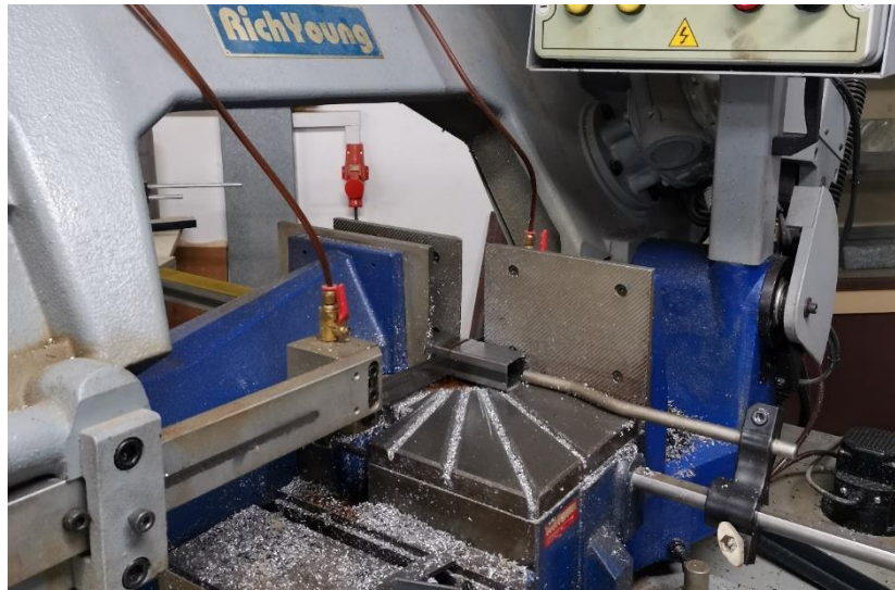
Εικόνα 4 . 2 . 1: Διαδικασία κοπής δοκιμών με ηλεκτρικό πριόνι
