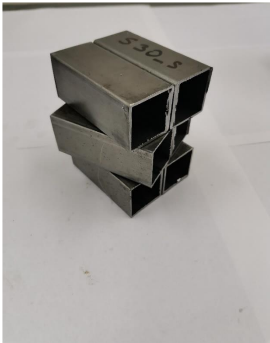
Εικόνα 4.2.5: : Πειραματικές Διατάξεις Δοκιμών Χάλυβα ( S45_S & S30_S) για στατική φόρτιση
