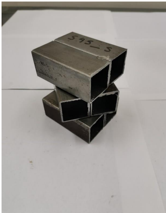
Εικόνα 4.2.5: : Πειραματικές Διατάξεις Δοκιμών Χάλυβα ( S45_S & S30_S) για στατική φόρτιση
