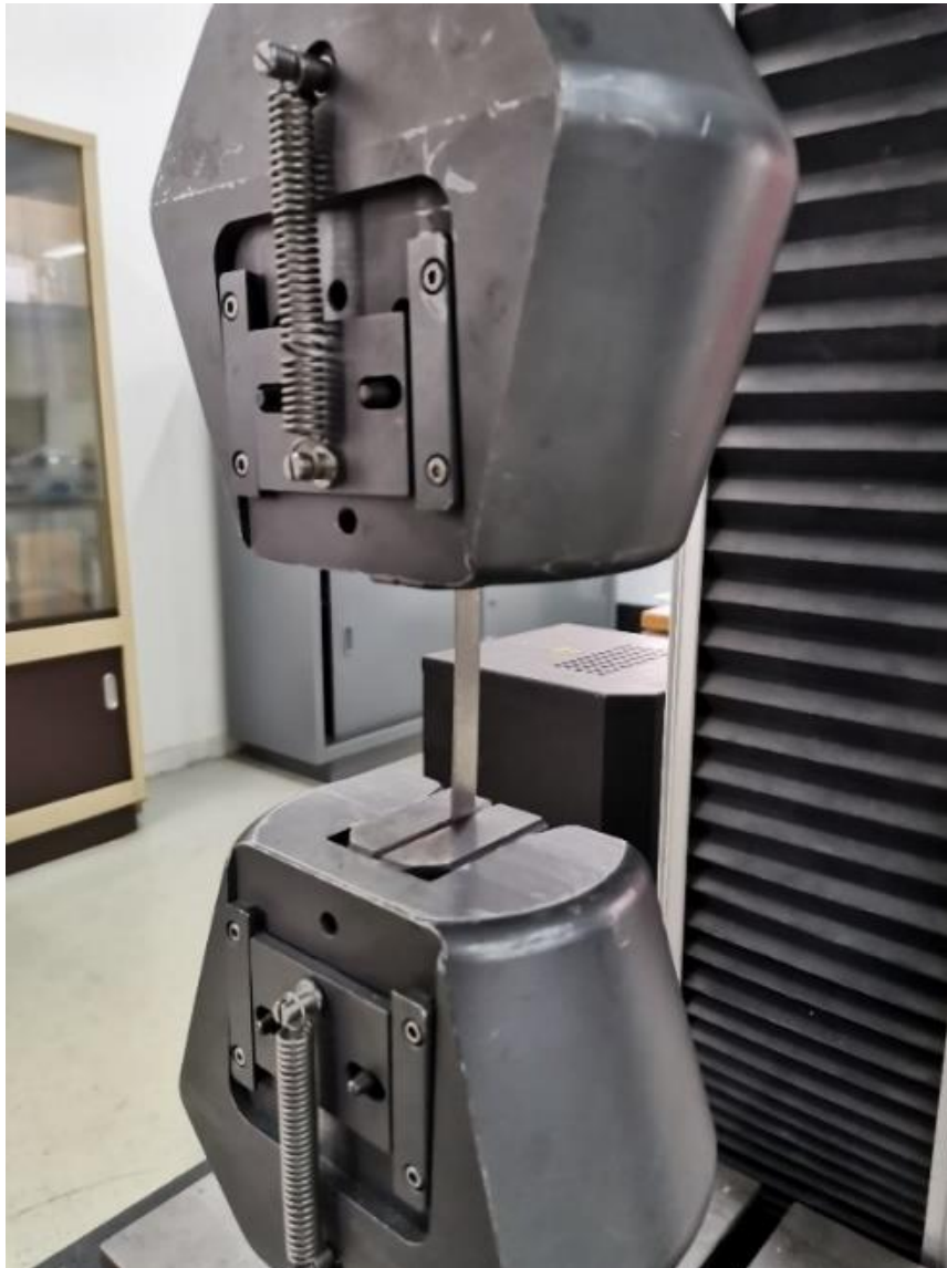
Εικόνα 4 . 2 . 3: Χρήση αρπαγών για εφελκυστικές δοκιμές
