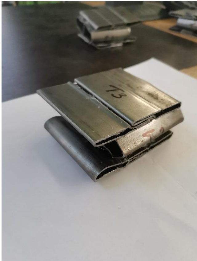
Εικόνα 5 . 2 . 2: Δοκίμιο S90_D (T3) μετά την κρούση
