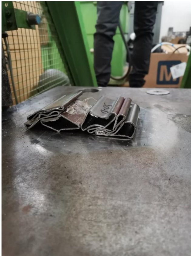
Εικόνα 5 . 2 . 3: Δοκίμιο S0_D μετά την κρούση
