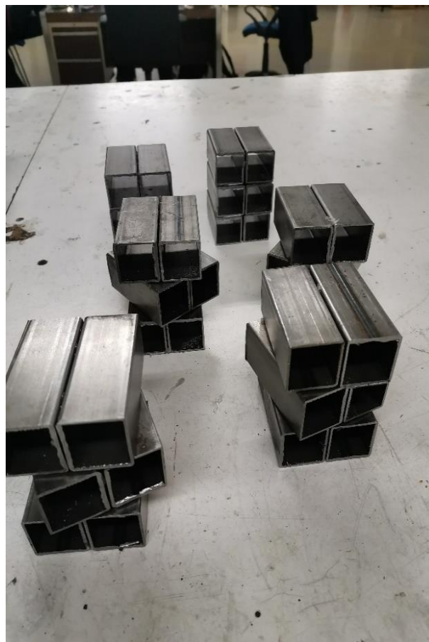
Εικόνα 4 . 2 . 12: Δομές για δοκιμή επιβολής θλιπτικού φορτίου
