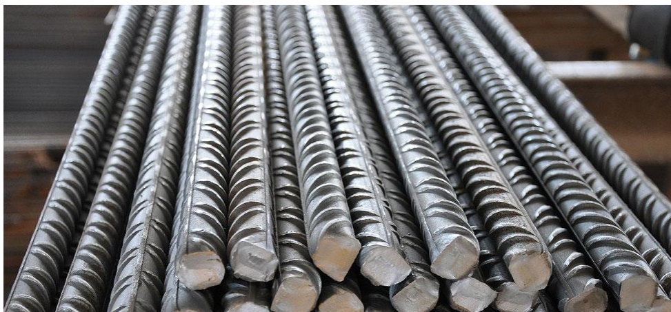
Εικόνα 3.1.1: Χάλυβας Οπλισμού Σκυροδέματος σε Ευθύγραμμες Ράβδους
