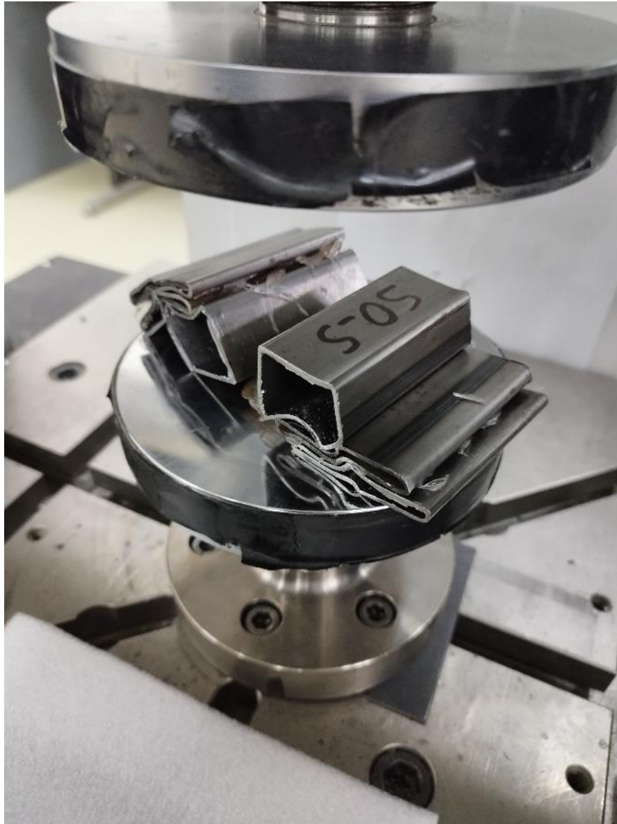
Εικόνα 5 . 1 . 1: S0_S μετά την κατάρρευση
