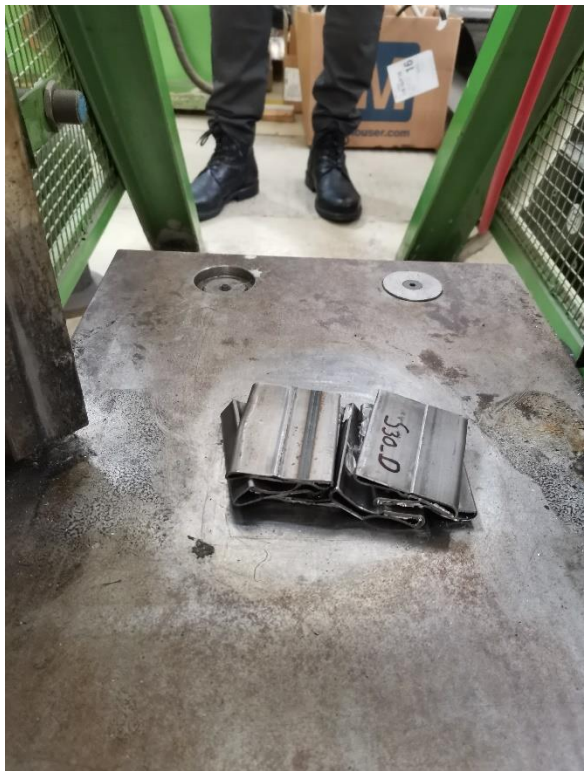
Εικόνα 5 . 2 . 4: Δοκίμιο S30_D μετά την κρούση
