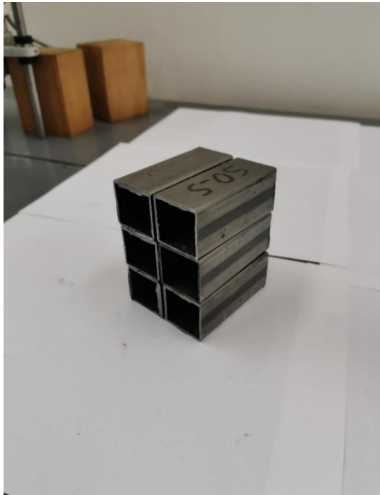
Εικόνα 4.2.6: : Πειραματικές Διατάξεις Δοκιμών Χάλυβα ( S0_S & S90_S) για στατική φόρτιση
