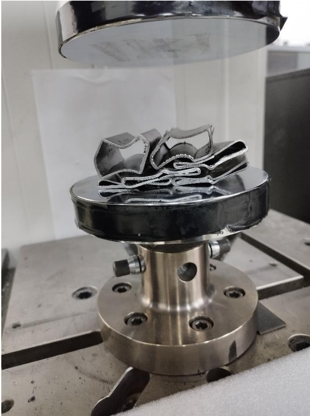
Εικόνα 5.1.2: S30_S μετά την κατάρρευση
