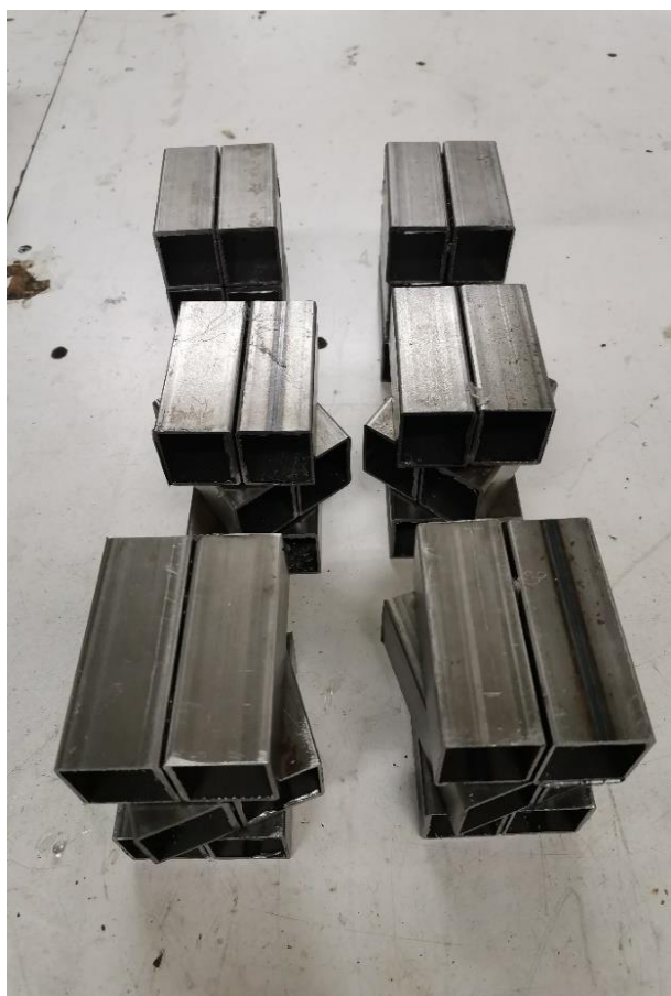
Εικόνα 4 . 2 . 12: Δομές για δοκιμή επιβολής θλιπτικού φορτίου
