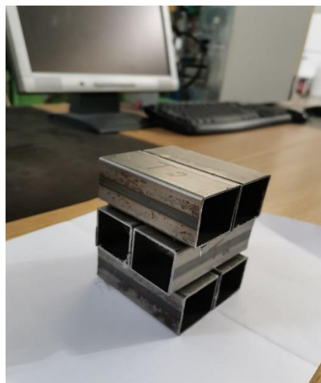
Εικόνα 4.1.2: Δομές για δοκιμή επιβολής θλιπτικού φορτίου
