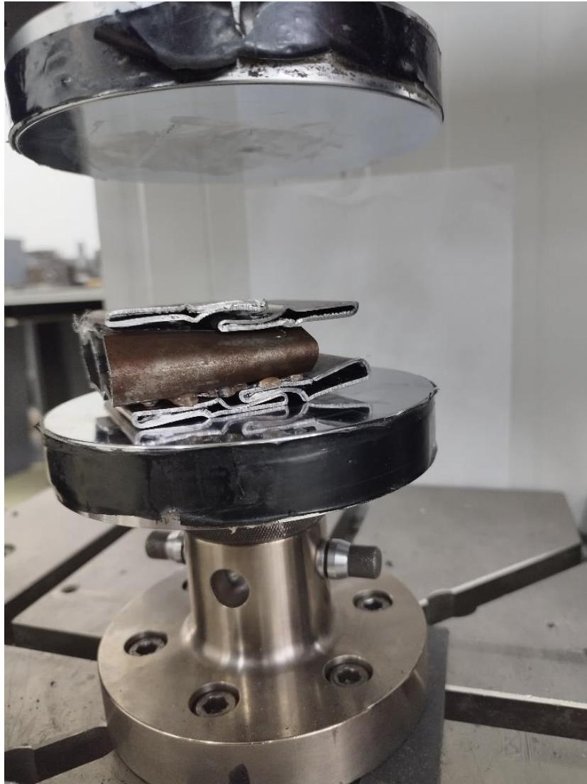
Εικόνα 5 . 1 . 4: S90_S μετά την κατάρρευση
