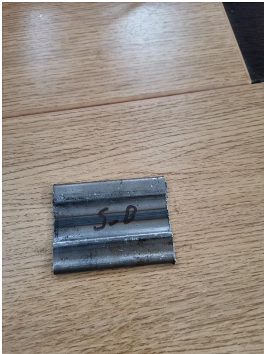
Εικόνα 4. 2. 8: Μεμονωμένο δοκίμιο S-A υπό πλευρική δυναμική καταπόνηση
