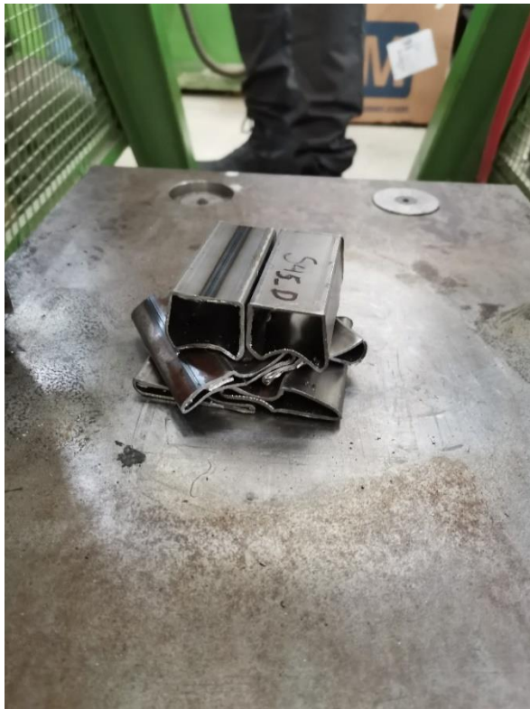
Εικόνα 5 . 2 . 5: Δοκίμιο S45_D μετά την κρούση
