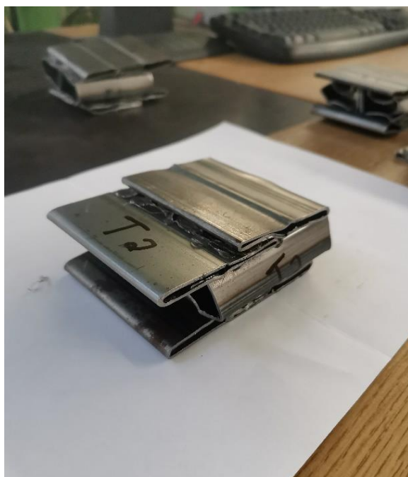
Εικόνα 5 . 2 . 1: Δοκίμιο S90_D (T2) μετά την κρούση
