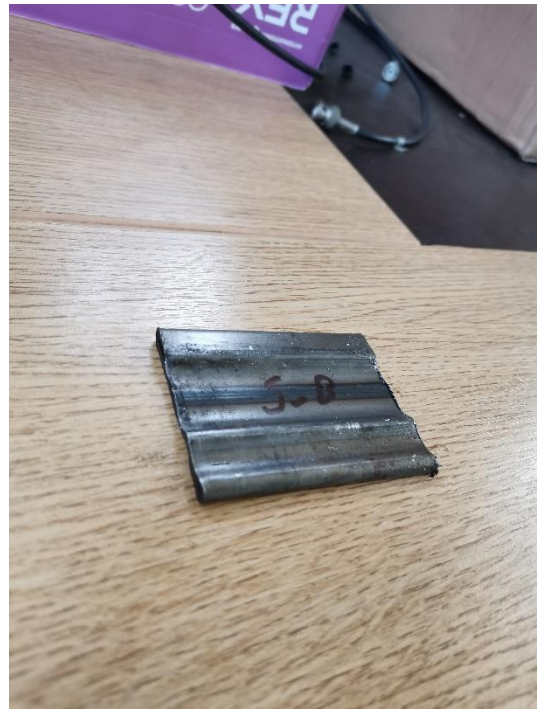
Εικόνα 4. 2. 8: Μεμονωμένο δοκίμιο S-A υπό πλευρική δυναμική καταπόνηση
