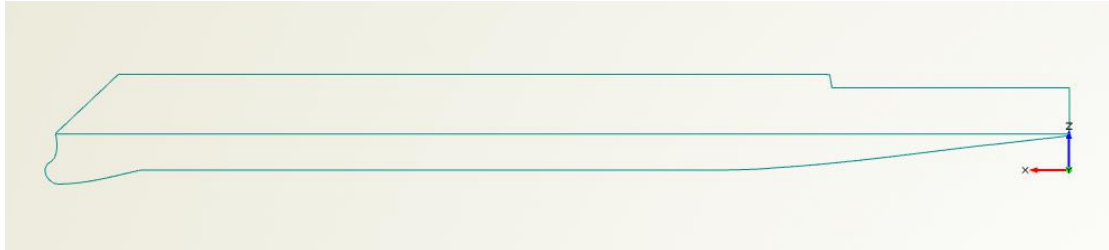
Σχήμα 10: Προφίλ των συνοριακών καμπυλών του πλοίου
