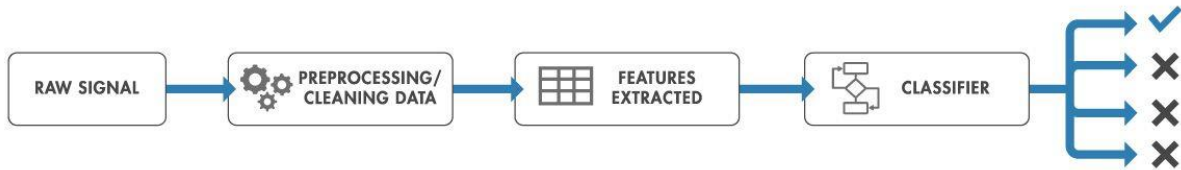
Figure 12 Σχήμα για την εφαρμογή της διαδικασίας εξαγωγής χαρακτηριστικών σε ένα σύνολο δεδομένων που τροφοδοτεί ένα μοντέλο ταξινόμησης [49]
