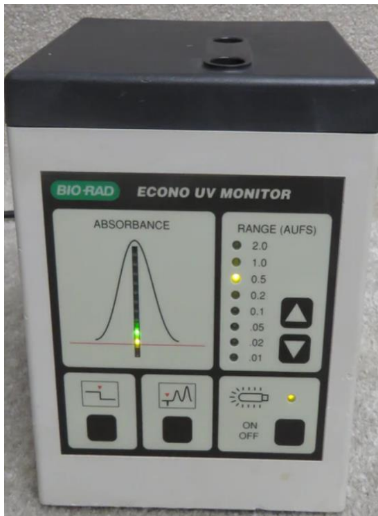
Εικόνα 2.9. Ανιχνευτής UV (αριστερά), Μονάδα ρύθμισης του προγράμματος της περισταλτικής αντλίας (δεξιά).
