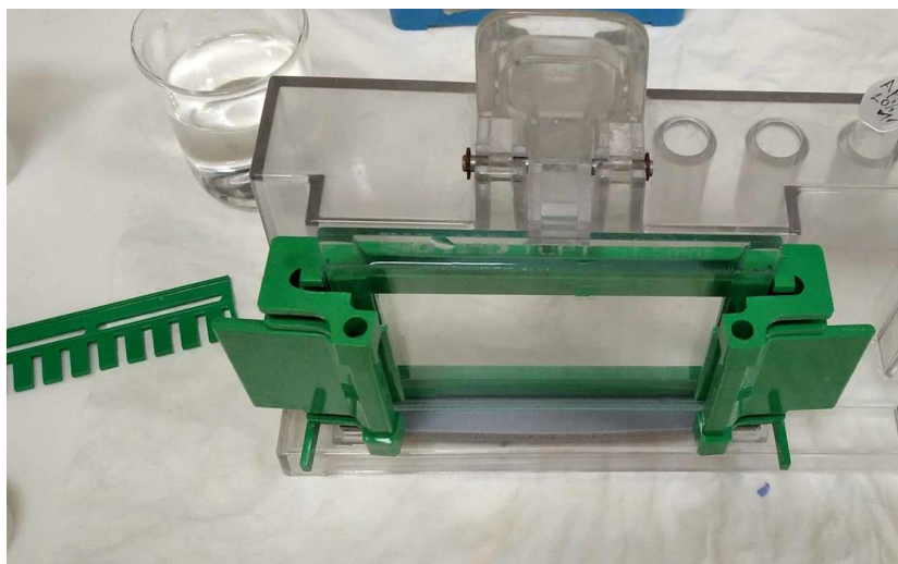
Εικόνα 2.10. Διάταξη στήριξης των δύο γυάλινων πλακών και καλούπι σχηματισμού υποδοχών δείγματος (αριστερά). Το διάκενο έχει συμπληρωθεί μέχρι την κορυφή με τα διαλύματα.
