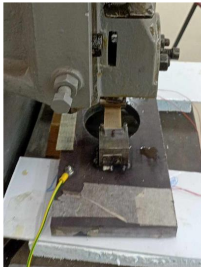
Εικόνα 33 Η μόνωση και η γείωσης της ζυγαριάς
