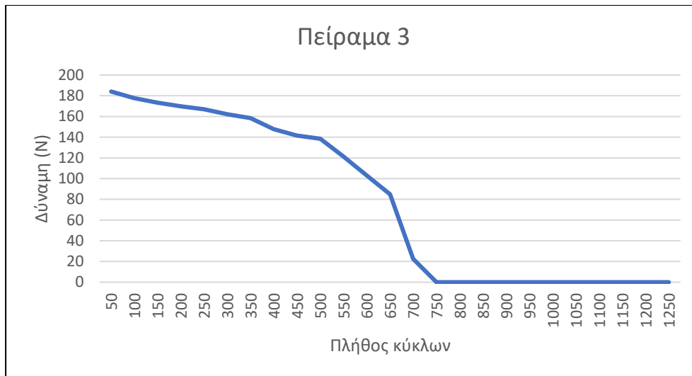
Διάγραμμα 5 Διάγραμμα δύναμης-κύκλων κόπωσης για το τρίτο πείραμα
