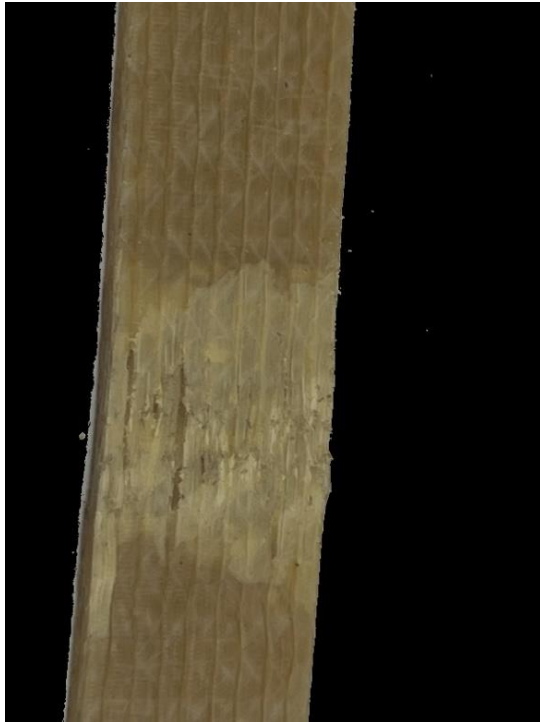
Εικόνα 23 Δοκίμιο με αστοχία ύστερα από την αποκοπή της εικόνας
