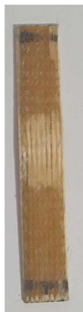
Εικόνα 21 Σπασμένο δοκίμιο ύστερα από κάμψη τριών σημείων
