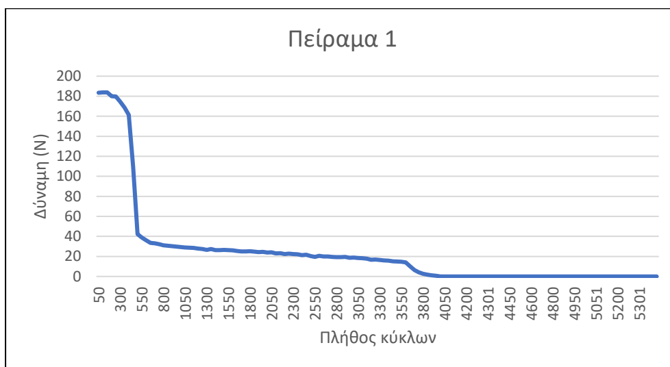
Διάγραμμα 3 Διάγραμμα δύναμης-κύκλων κόπωσης για το πρώτο πείραμα
