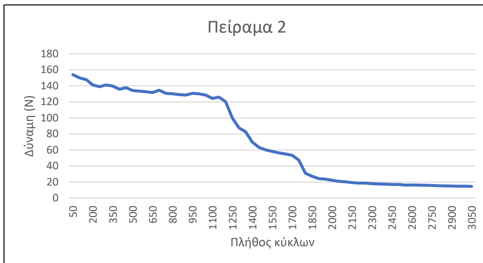
Διάγραμμα 4 Διάγραμμα δύναμης-κύκλων κόπωσης για το δεύτερο πείραμα
