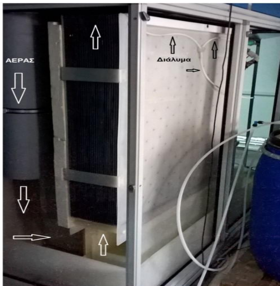
Εικόνα 9. Ροή διαλύματος-αέρα στον αναγεννητή
