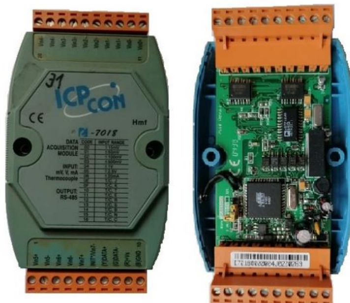
Εικόνα 21. Περιβλήμα και εσωτερικό του module I7018
