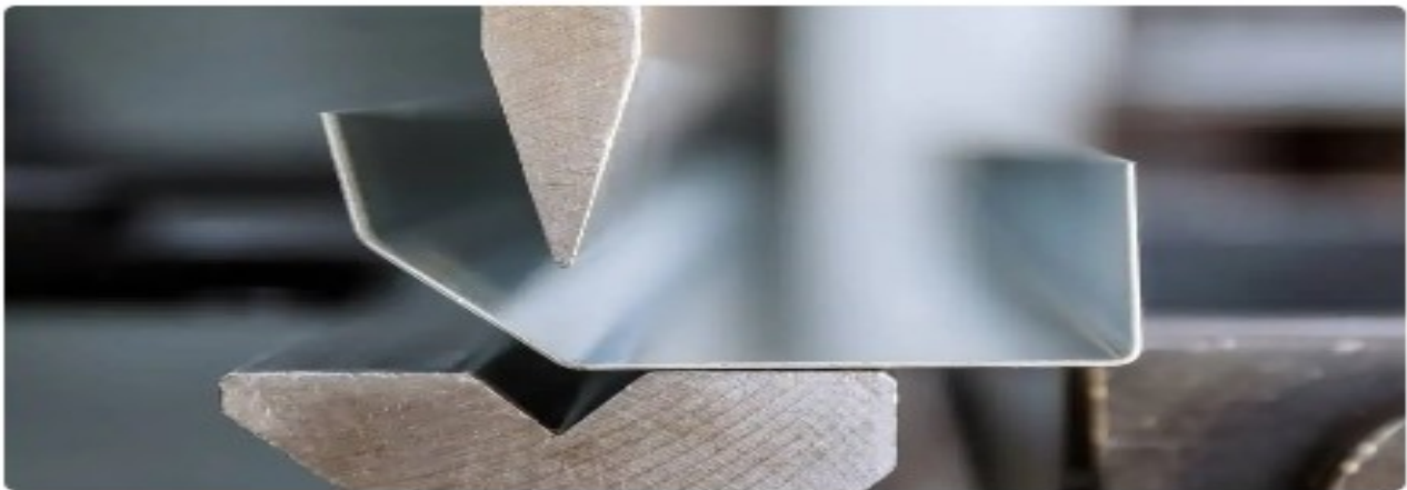
Εικόνα 3.8: Κατεργασία κάμψης μετάλλου [17]
