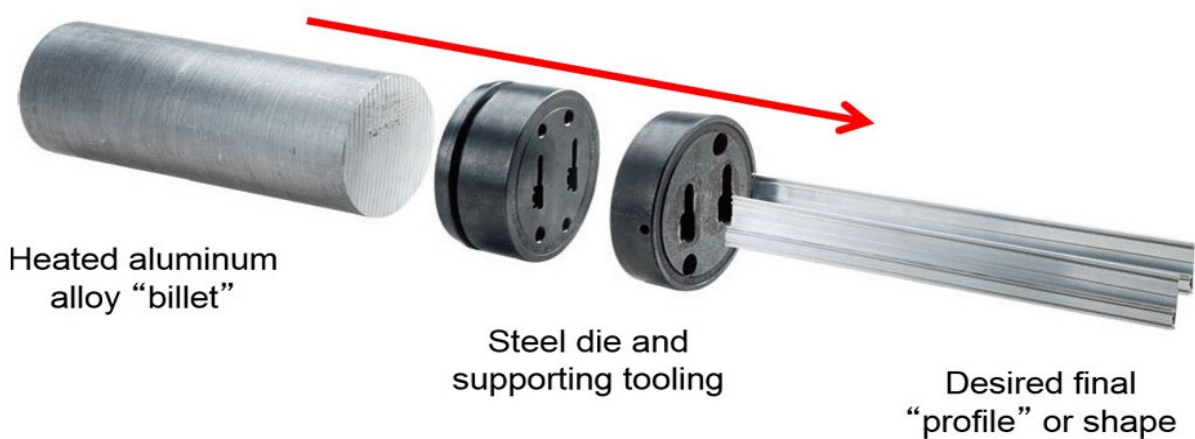
Εικόνα 3.3: Εξώθηση αλουμινίου [10]
