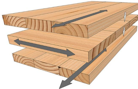
Εικόνα 3.1 Αναπαράσταση της δομής της σταυρωτής επικολλητής ξυλείας (Reid Middleton, 2017).
