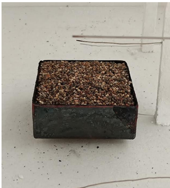
Εικόνα 5.15 Ο καυστήρας μέσα στο πυροδιαμέρισμα.
