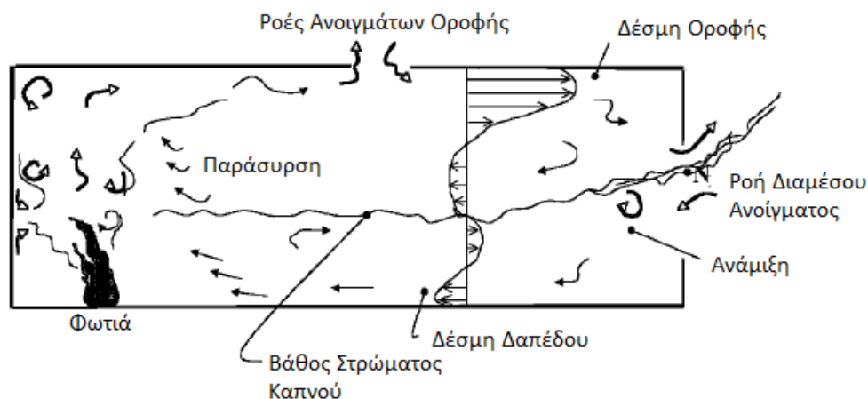
Εικόνα 2.1 Ροϊκό πεδίο φωτιάς σε διαμέρισμα με άνοιγμα
