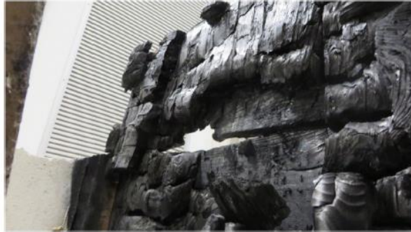
Εικόνα 4.2 Αποκόλληση lamella μέχρι και στο πέμπτο στρώμα, Crielaard et al 2019
