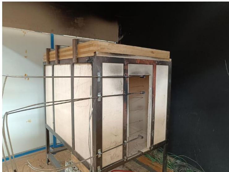
Εικόνα 5.10 Διάταξη του πυροδιαμερίσματος με CLT οροφή.
