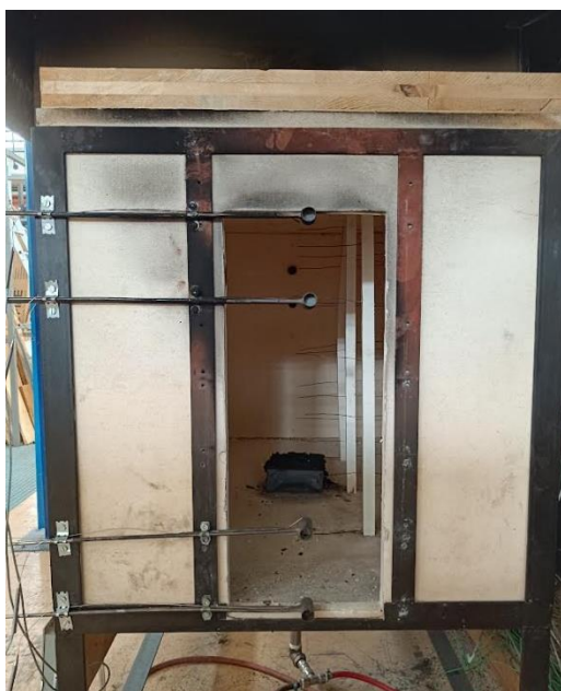
Εικόνα 5.3 Πρόσοψη και πλάγια όψη από αριστερά του πυροδιαμερίσματος με CLT οροφή.
