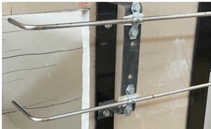
Εικόνα 5.8 Δύο σωλήνες Pitot στο άνοιγμα του διαμερίσματος.
