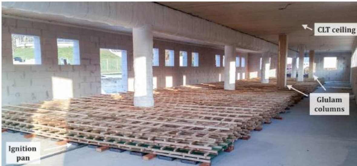
Εικόνα 4.5 Εσωτερικό του πυροδιαμερίσματος CodeRed #1 , Kotsovinos et al, 2022
