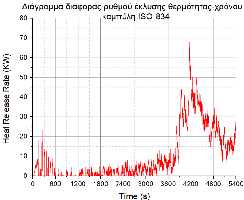
Σχήμα 6.68 Διάγραμμα διαφοράς ρυθμού έκλυσης θερμότητας των πειραμάτων που ακολουθούν την καμπύλη ISO-834.
