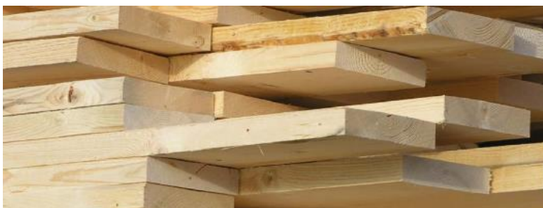
Εικόνα 3.2 Πλάκες για κατασκευή CLT.
