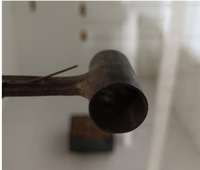
Εικόνα 5.12 Στερεοποίηση θερμοστοιχείων ανοίγματος επάνω στους μετρητές ταχύτητας.
