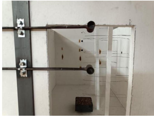
Εικόνα 5.6 Δικατευθυντικοί μετρητές τοποθετημένοι στο άνοιγμα.
