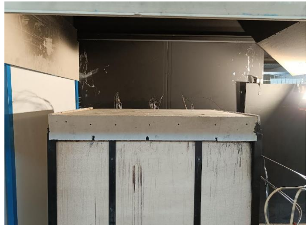
Εικόνα 5.4 Πρόσωση και πλάγια όψη από αριστερά του πυροδιαμερίσματος με οροφή CLT στα πειράματα της εργασίας.
