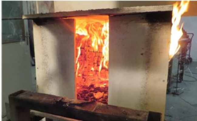
Εικόνα 4.1 Πείραμα με 3 CLT τοίχους, Crielaard et al 2019
