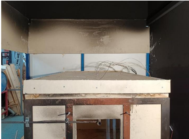
Εικόνα 5.4 Πρόσωση και πλάγια όψη από αριστερά του πυροδιαμερίσματος με οροφή CLT στα πειράματα της εργασίας.
