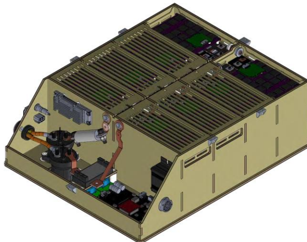
Εικόνα 5: Συσσωρευτής ενέργειας της ομάδας PROM Racing για το μονοθέσιο P22
