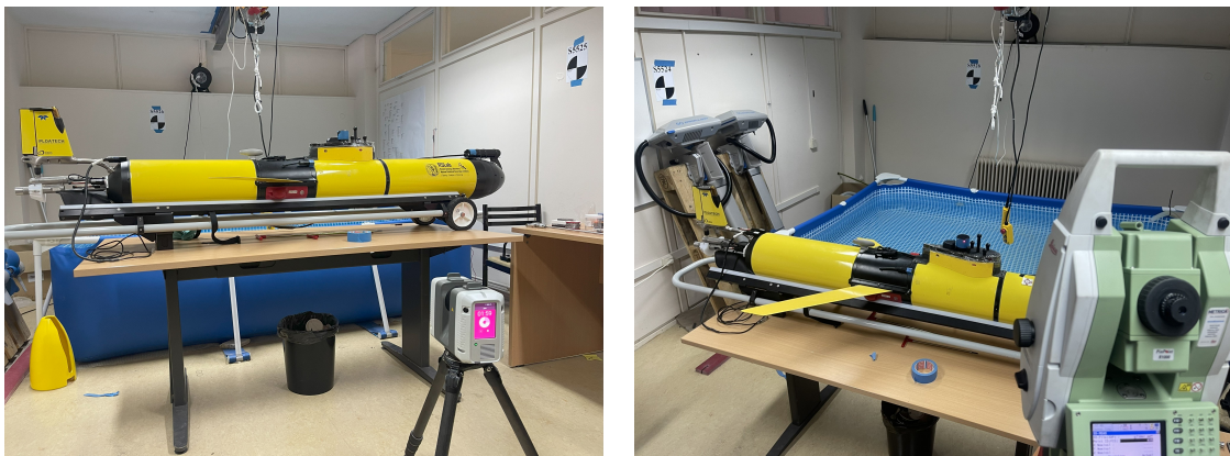
Εικόνα 3.30: Στιγμιότυπα από τη διαδικασία αποτύπωσης του ρομποτικού συστήματος τύπου Glider μέσα από τη χρήση τεχνολογίας Laser Scanner (Leica RTC 360) και Γεωδαιτικού Σταθμού (Leica TDRA 6000).
