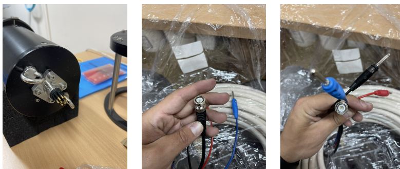
Εικόνα 3.39: Συνδεσιμότητα αισθητήρα Evologics USBL S2CR 18/34.
