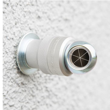
Εικόνα 3.16: Στόχοι Bohnenstingl - Παρελκόμενα Leica TDRA6000.
