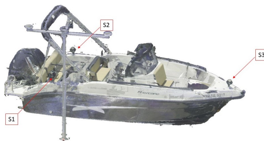
Εικόνα 3.19: Θέσεις Τοποθέτησης στόχων HDS κατά την αποτύπωση του σκάφους Αποστολής
