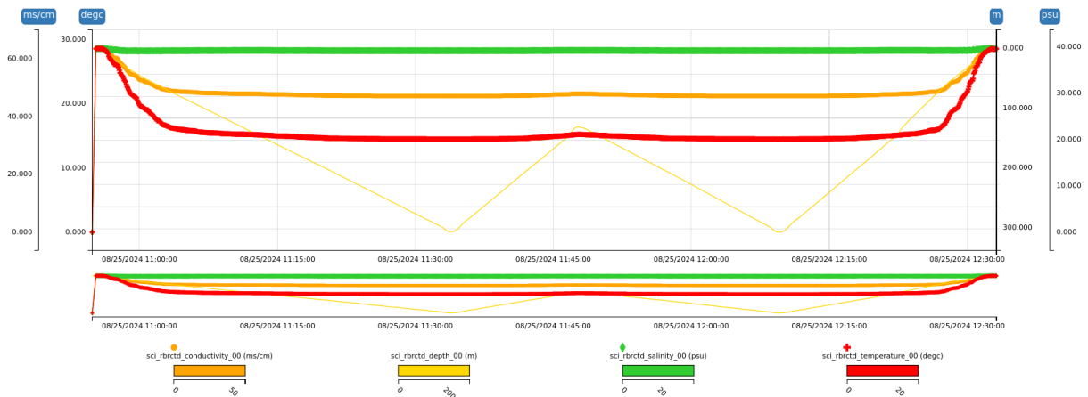
Εικόνα 4.23: Διάγραμμα θερμοκρασίας, αγωγιμότητας, αλατότητας αλλά και βάθους στη περίπτωση χρήσης ελικοειδούς βύθισης σε βάθος των 300 μέτρων
