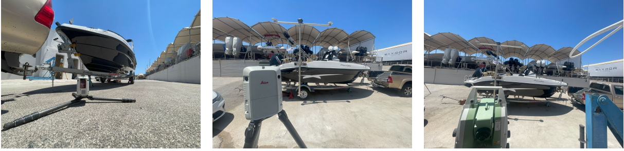
Εικόνα 3.22: Στιγμιότυπα από τη διαδικασία αποτύπωσης του σκάφους μέσα από τη χρήση τεχνολογίας Laser Scanner (Leica RTC 360) και Γεωδαιτικού Σταθμού (Leica TDRA 6000).
