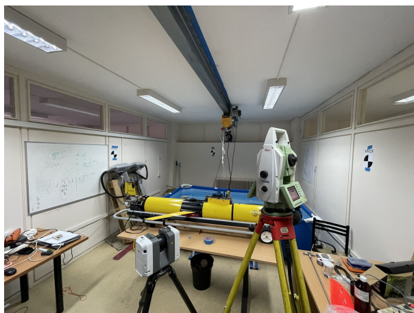
Εικόνα 3.28: Θέσεις Στόχων HDS κατά την Τρισδιάστατη Αποτύπωση του Glider
