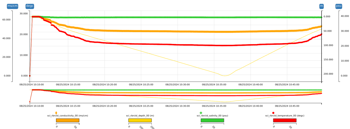
Εικόνα 4.15: Διάγραμμα θερμοκρασίας, αγωγιμότητας, αλατότητας αλλά και βάθους στη περίπτωση χρήσης ελικοειδούς βύθισης σε βάθος των 200 μέτρων
