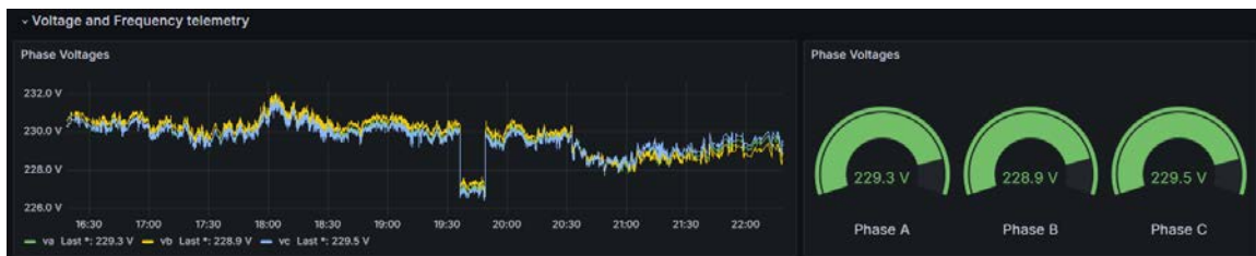
Σχήμα 6.29: Grafana dashboard – Ένδειξη και καταγραφή RMS τιμής φασικών τάσεων σε πραγματικό χρόνο.
