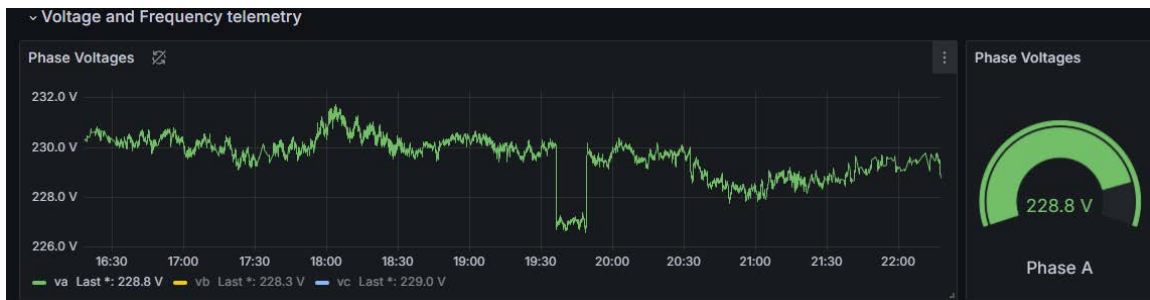
Σχήμα 6.28: Grafana dashboard – Ένδειξη και καταγραφή RMS τιμής φασικής τάσης σε πραγματικό χρόνο.
