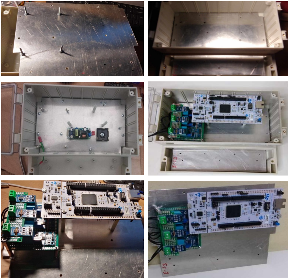
Σχήμα 7.8: Όψη τριφασικού έξυπνου μετρητή ενέργειας κατά τη διάρκεια κατασκευής (συνέχεια).
