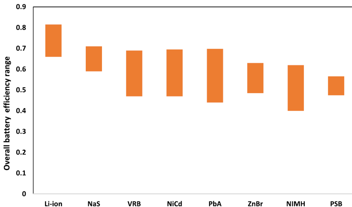
Εικόνα 25 Απόδοση των μπαταριών συμπεριλαμβανομένης της παραγωγής και της μεταφοράς της φόρτισης της μπαταρίας και του μετατροπέα. Περίπτωση 1: διάρκεια ζωής περιορισμένη από τον κύκλο ζωής, T=25^{\circ}\text{C} , υλικά μπαταρίας 100% ανακυκλώσιμα (Torabi & Ahmadi, 2020)
