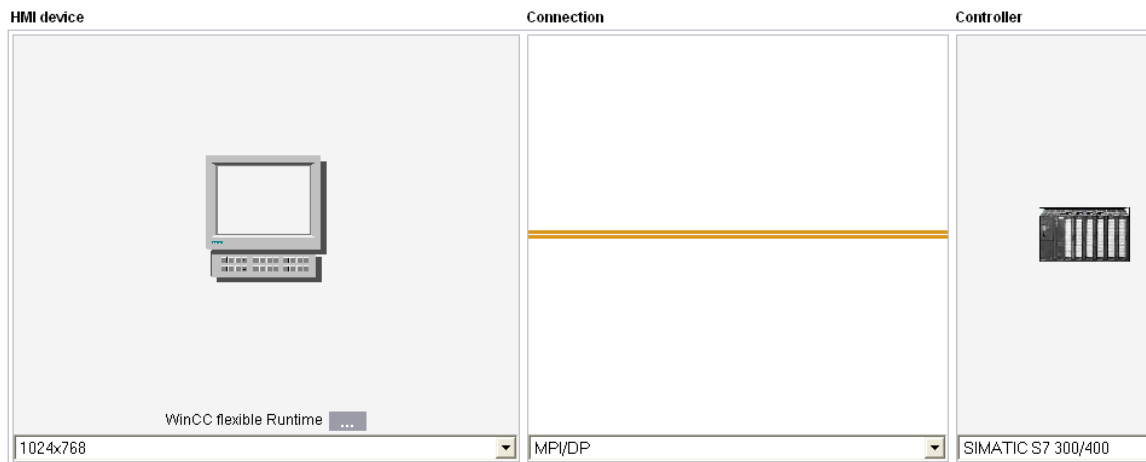
Σχήμα 7.3 Τρόπος επικοινωνίας μεταξύ υπολογιστή και PLC
