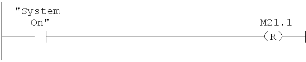
Σχήμα 6.9 Κυκλώματα κατασκευής της μεταβλητής LogTag
