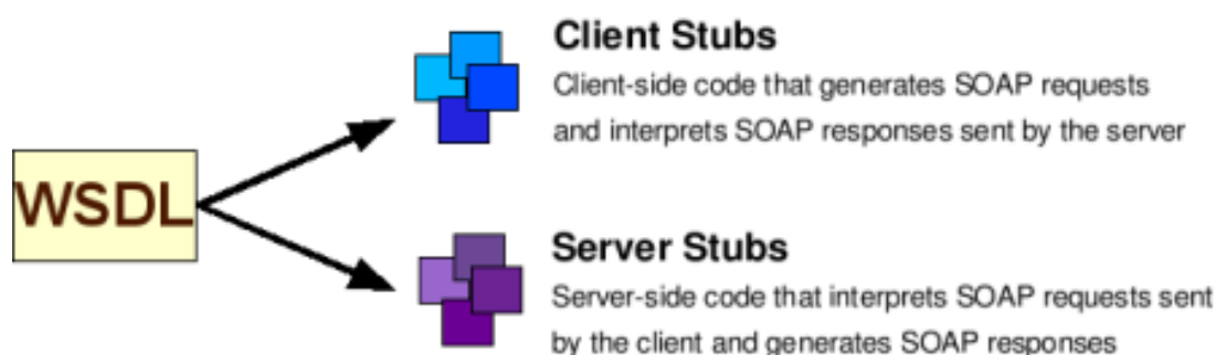
Εικόνα 3.6 Τα stubs για τον Client και τον Server παράγονται από το αρχείο WSDL
