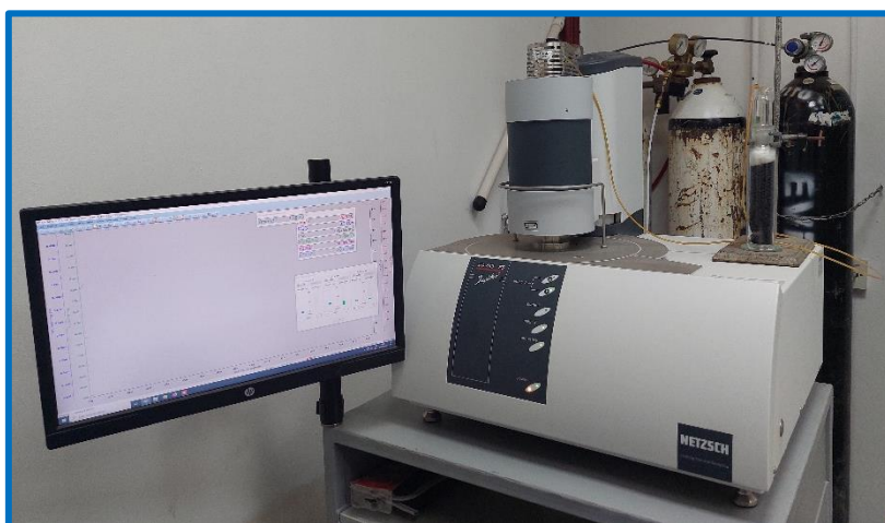
Σχήμα 13: Θερμικός αναλυτής STA 449 F5 Jupiter
