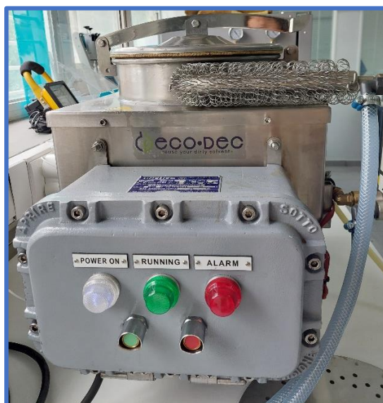
Σχήμα 22: Αναγεννητής ακετόνης EX 20 Wx της Eco-Dec
