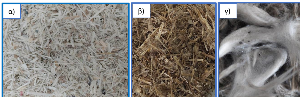
Σχήμα 41: α) GFRP πριν τη διαλυτόλυση, β) Ανεπιτυχής διαλυτόλυση GFRP (B2B SC1), γ) Επιτυχής διαλυτόλυση GFRP (B2B SC15)
