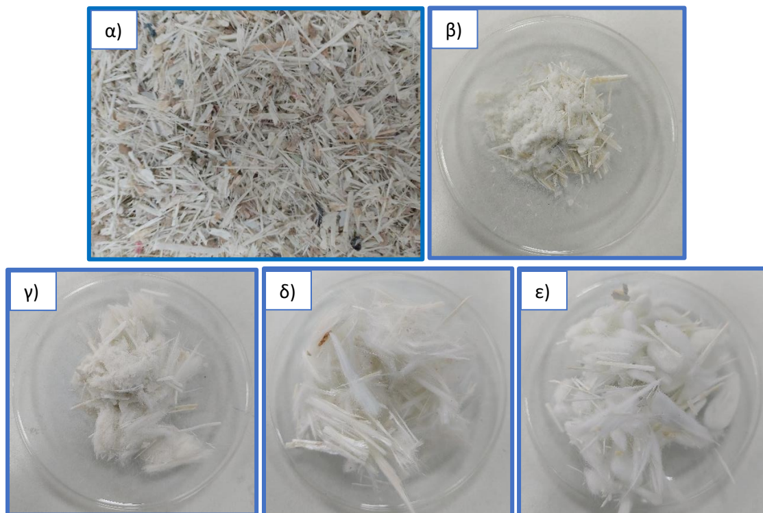
Σχήμα 27: α) GFRP (πριν τη διαλυτόλυση), β) θρυμματισμένες rGF, γ) εύθραυστες rGF, δ) rGF με υψηλά ποσοστά ρητίνης και ε) rGF στη βέλτιστη κατάσταση
