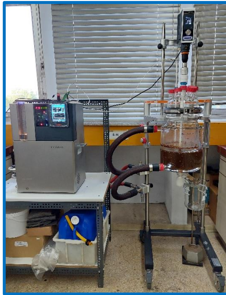
Σχήμα 17: Πειραματική διάταξη διαλυτόλυσης με PEG200 σε πιλοτική κλίμακα
