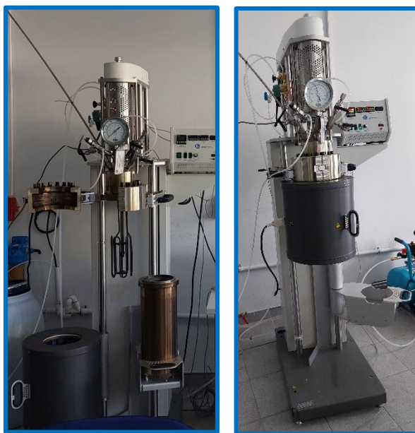
Σχήμα 18: Πειραματική διάταξη διαλυτόλυσης με υπερκρίσιμη ακετόνη (δεξιά σε λειτουργία)
