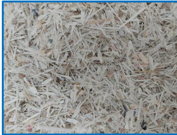
Σχήμα 14: Τεμαχισμένο δείγμα WTB πριν την προεπεξεργασία
