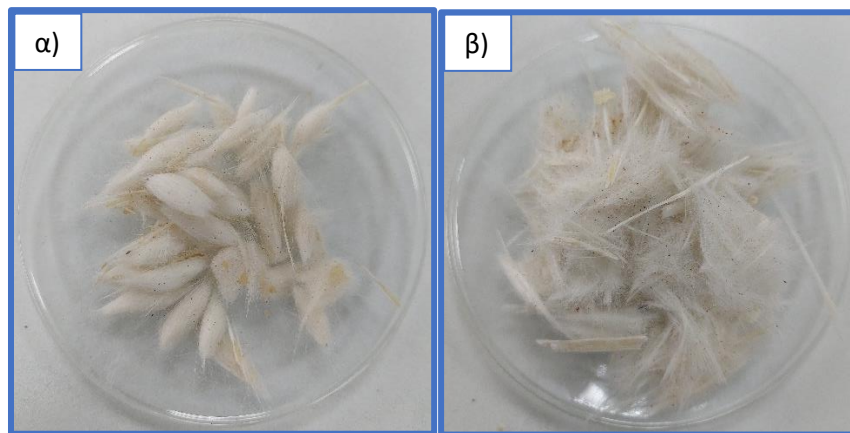
Σχήμα 34: α) rGF μετά από 5 h διαλυτόλυση στον 10 L batch, β) rGF μετά από 5.5 h διαλυτόλυση στον 10 L batch
