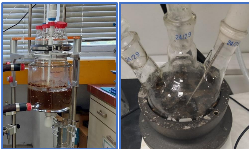
Σχήμα 23: Το καφέ χρώμα οφείλεται στην αποικοδόμηση του PEG
