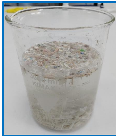
Σχήμα 15: Διαχωρισμός WTB – ξένων υλικών με βάση την πυκνότητα
