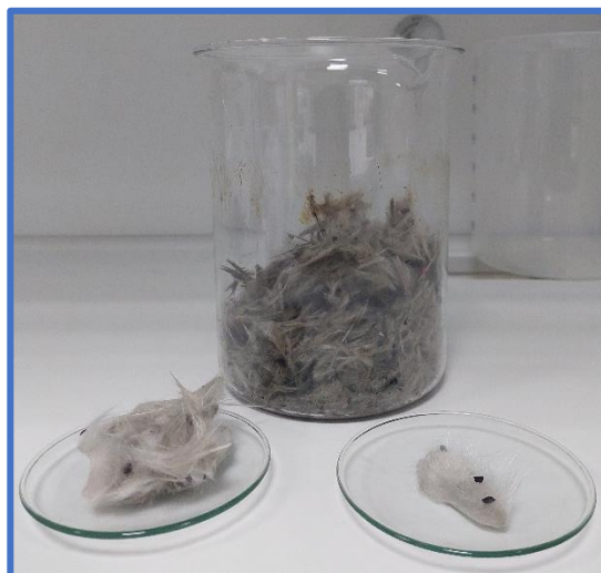
Σχήμα 78: rGF μετά (ποτήρι ζέσεως) και πριν το λουτρό υπερήχων (ύαλοι ωρολογίου)
